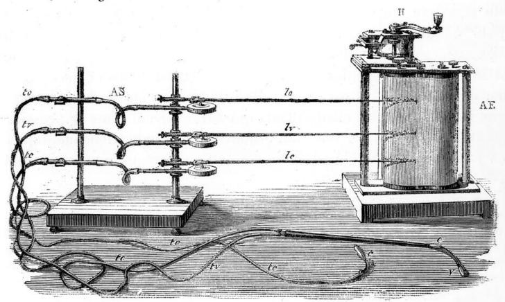
L'instrument se compose de deux éléments principaux : A E, l'appareil enregistreur, et AS, l'appareil sphygmographique, c'est-à-dire celui qui reçoit, transmet et amplifie les mouvements qu'il faut étudier.
