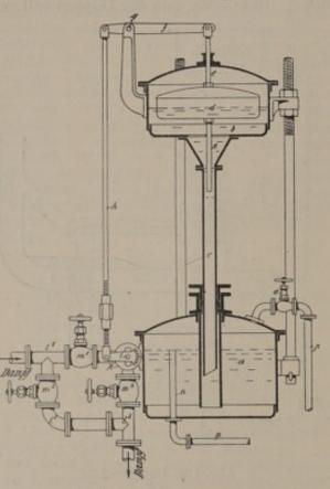
Abb. 120. Savalles Dampfregler für Destillier- und Rektifizierapparate.
