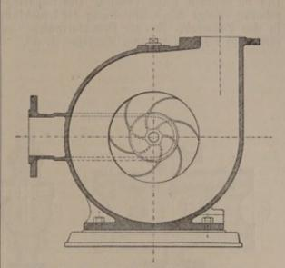
Abb. 439. Einfache Niederdruckkreiselpumpe.
