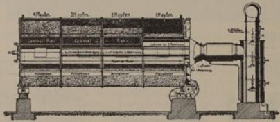
Abb. 419. Mehrhaufen-Keimtrommel.
