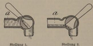
Abb. 345. Läuterhahn mit Flüssigkeitsverschluß.
