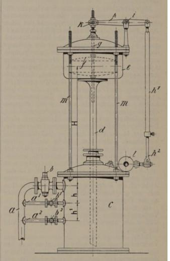
Abb. 121. Savalles Dampfregler für Destillier- und Rektifizierapparate.
