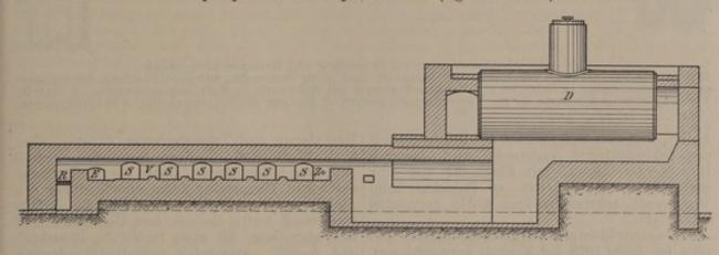
Abb. 383. Gamerofen zur Erzeugung von Melasseschlempekohle. R Rost zur Verbrennung von Kohle (nur bei Einleitung der Melasseschlempeverkohlung in Gebrauch), Z Eintritt der Schlempe, E Austritt der Schlempekohle, S Schüröffnungen, D Dampfkessel.
