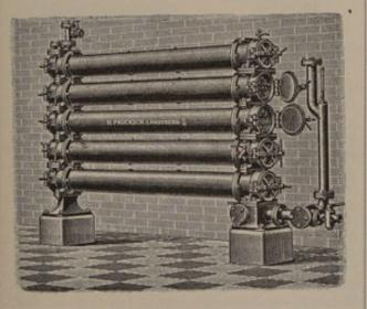
Abb. 363. Röhrenkühler für Maische und Würze.
