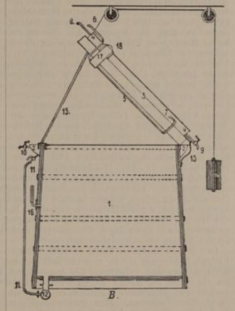
Abb. 189. Gärbottich mit geöffnetem Deckel.
