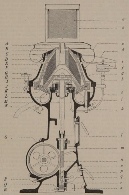
Abb. 537. Hefe-Separator "Alfa-Laval" mit Zahnradantrieb.
