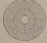
Abb. 341. Zusammengesetzter Läuterboden.
