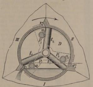
Schnitt senkrecht zur Trommelachse. Abb. 431 u. 432. Spiritusprobenehmer. Vorrichtung zur Entnahme der Proben.
