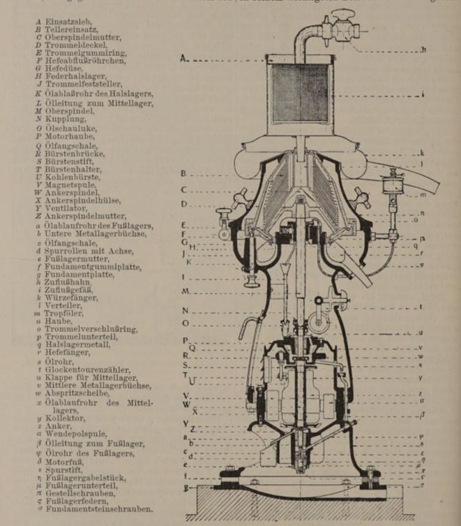
Abb. 536. "Westfalia"-Hefe-Separator mit eingebautem Elektromotor (Längsschnitt).
