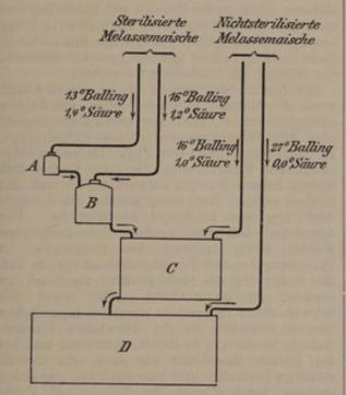
Abb. 378. Schematische Darstellung der Hefebereitung und des Gärverfahrens einer Melassebrennerei. A Kleiner Hefereinzuchtapparat . 1 hl Inhalt. B Großer Heferelnzuchtapparat . 10 " "
