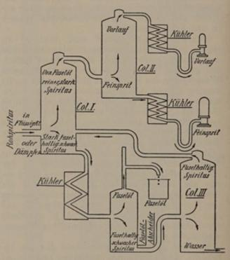
Abb. 455. Schematische Darstellung der Arbeitsweise des Ilgesschen Destillier-Rektifizierapparates.
