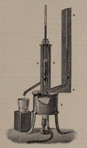
Abb. 595. Vaporimeter.
