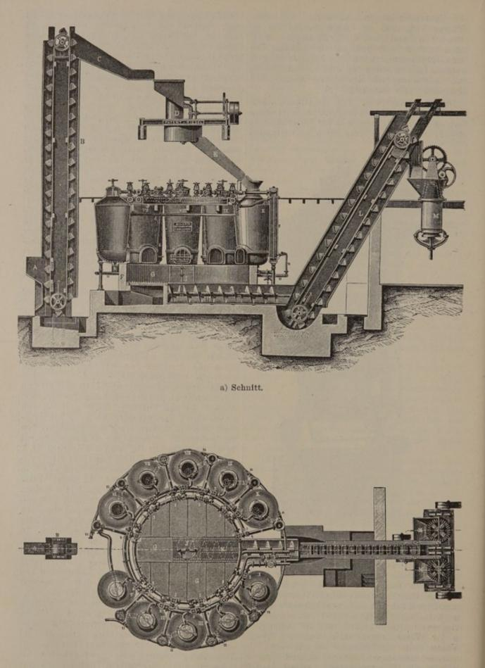
b) Grundriß. Abb. 132. Diffusionsbatterie in kreisförmiger Anordnung.
