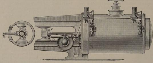
Abb. 271. Befestigung der Indikatoren an den Zylinder.
