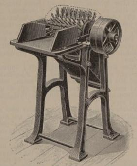
Abb. 173. Reißwolf für die Zerkleinerung von Filzmalz.
