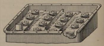
Abb. 459. Boden der Rektifiziersäule von Barbet mit am unteren Rande kammförmig geschlitzten Glocken.
