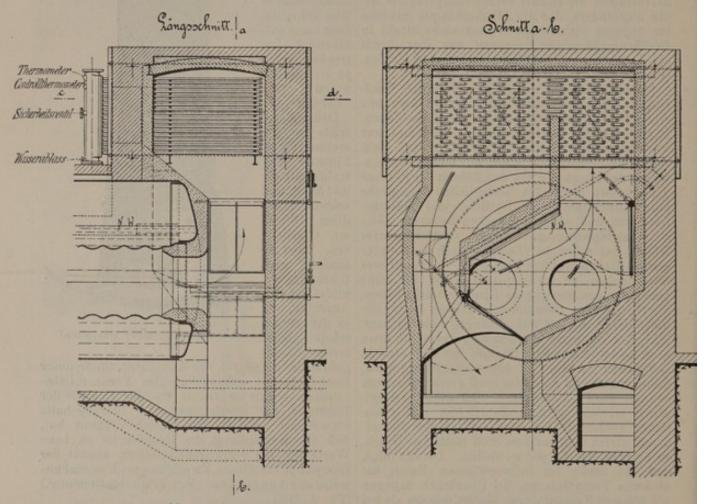
Abb. 123. Dampfüberhitzer, oberhalb des Dampfkessels eingebaut.
