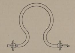
Abb. 34. Federrohr als Ausgleichvorrichtung für Rohrleitungen.
