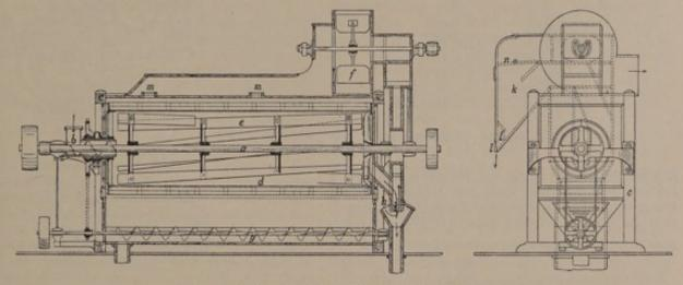
Abb. 372. Malzputz- und Entkeimungsmaschine.
