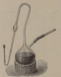
Abb. 401. Pasteurkolben auf Korkuntersatz.
