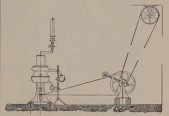
Abb. 535. Separator für kontinuierlichen Betrieb.
