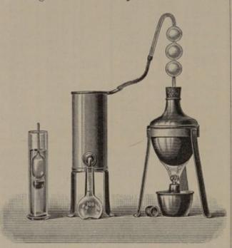
Abb. 13. Apparat zur Alkoholbestimmung.
