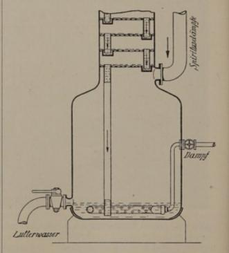
Abb. 352. Lutterblase eines älteren zweiteiligen Destillierapparats.
