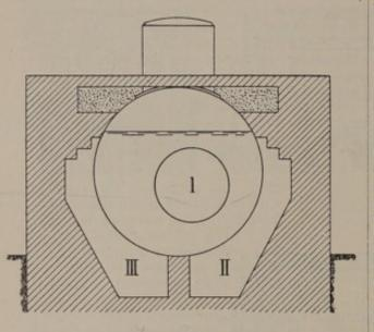
Abb. 113. Einmauerung für einen Einflammrohrkessel ohne Oberzug.
