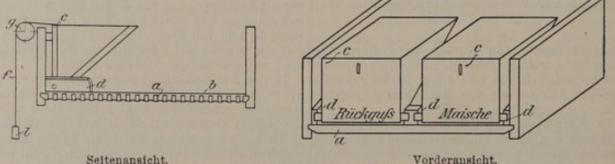
Abb. 515 u. 516. Ausziehbarer Siebboden mit Verteilungsvorrichtung. (System Clasing und Gilsdorf-Paderborn.)
