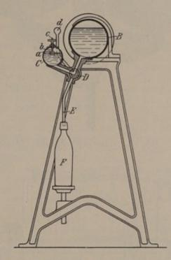
Abb. 175. Flaschenfüll-Apparat. (Querschnitt.)
