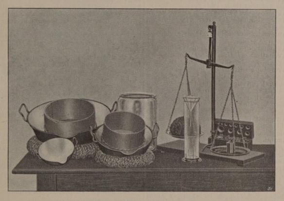
Abb. 36. Apparat zur Bestimmung der auswaschbaren Stärke.
