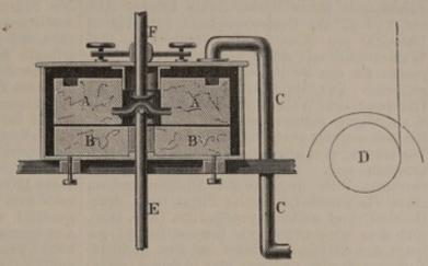
Abb. 505. Mahlgang mit Ventilation. A Läufer, B Bodenstein, C Rohr zum Exhaustor, D Exhaustor, E Mühleisen, F Einlauf.
