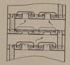
Abb. 324. Böden einer Maischedestilliersäule mit am unteren Rande kammförmig geschlitzten Glocken.
