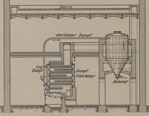
Abb. 315. Anlage zur Wiederbelebung der Filterkohle durch überhitzten Dampf.
