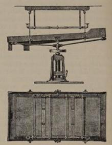
Abb. 338. Kreisschwingsieb.
