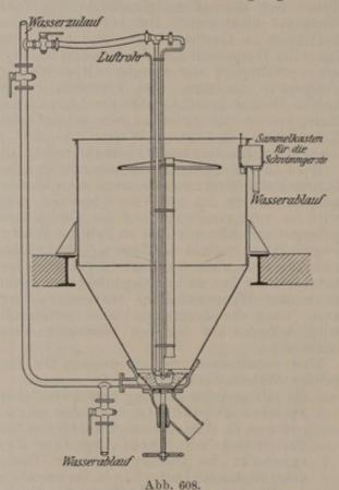
Weichstock mit Lüftungseinrichtung nach Lange.
