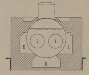
Abb. 111. Einmauerung für einen Zweiflammrohrkessel ohne Oberzug.
