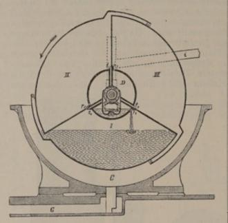
Abb. 550. Spiritusmeßapparat (Schnitt).
