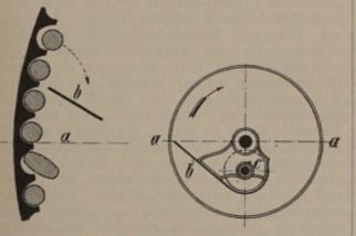
Abb. 230. Schnitt durch einen Trieurzylinder. Abb. 229. Teil eines Trieurmantels.
