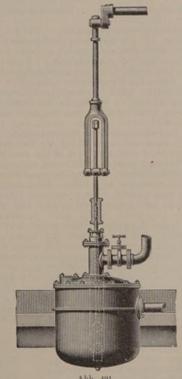
Abb. 491. In Schlempekessel eingebaute Schlempepumpe.
