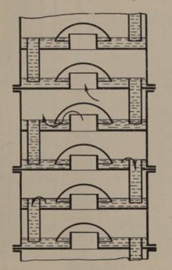
Abb. 322. Maischesäule eines kontinuierlichen Destillierapparates.
