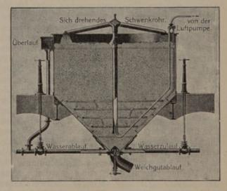
Abb. 610. Weichstock mit Lüftungseinrichtung System J. A. Topf & Söhne.
