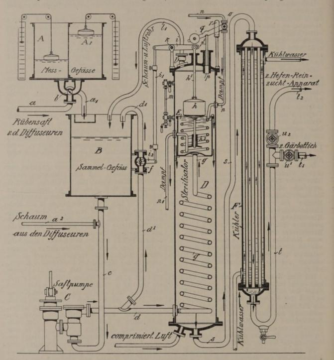
Abb. 472. Einrichtung für die fortlaufende Sterilisation des Rübensaftes nach Guillaume, Egrot & Grangé.
