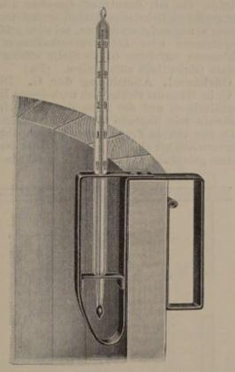
Abb. 193. Gärbottichthermometer.
