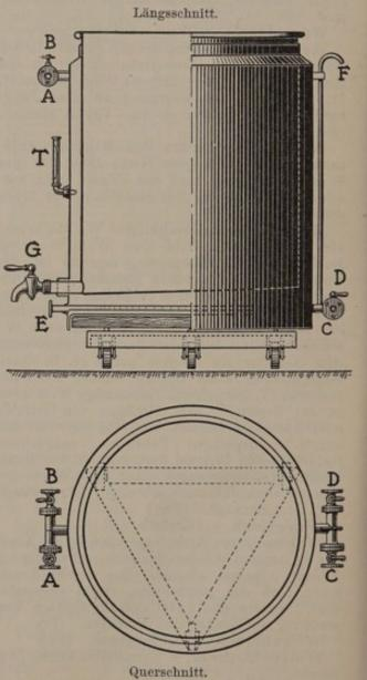
Abb. 604. Hefengefäß mit Wärmeschutzmantel. A Dampfeintritt, B Lufthahn und Wasserüberlauf, C Wassereintritt, D Kondenswasserablaßhahn, E Heizschlange, F Sicherheitsrohr, G Entleerungshahn für die fertige Hefe.
