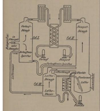
Abb. 456. Schematische Darstellung der Arbeitsweise eines Guillaumeschen kontinuierlichen Rektifizierapparates.
