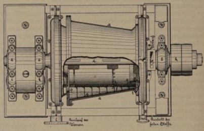
Abb. 582. Trennschleuder von Jahn.
