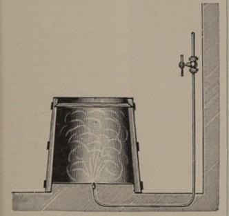
Abb. 255. Vorrichtung zum Ausdämpfen der Hefengefäße.
