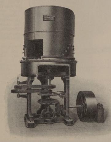
Abb. 473. Rübenschnitzelmaschine.
