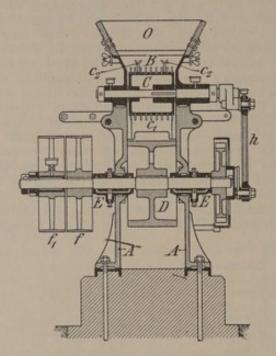
Abb. 373. Malzquetsche (Längsschnitt).
