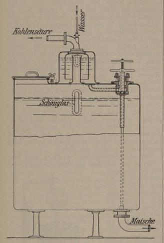
Gärkessel mit eigenartigem Ablaßventil Abb. 200. für das Kohlensäurewaschwasser in die Maische.
