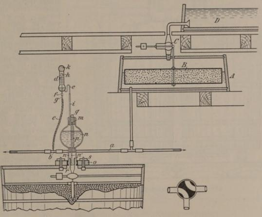
Abb. 517. Frings selbsttätige Auf- und Rückgußvorrichtung.
