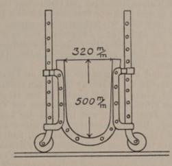
Abb. 514. Querschnitt durch eine zerlegbare eiserne Schwemmrinne.
