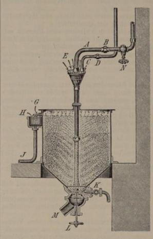
Abb. 609. Weichstock mit Lüftungseinrichtung nach Jänicke.
