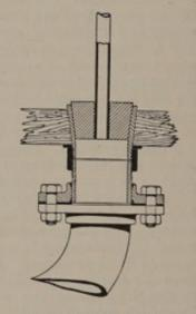
Abb. 492. Durchbohrtes Klotzventil mit Luftrohr für Schlempesammelbehälter.
