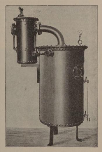
Abb. 347. Luftkühl- und Waschapparat.
