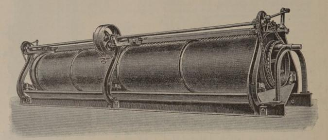
Abb. 91. Auswaschzylinder mit automatischem Bürstenwerk.
