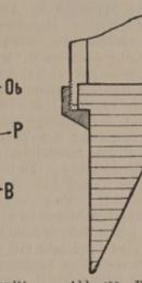
Abb. 449. Schematischer Schnitt das Eintauchdurch refraktometer.
