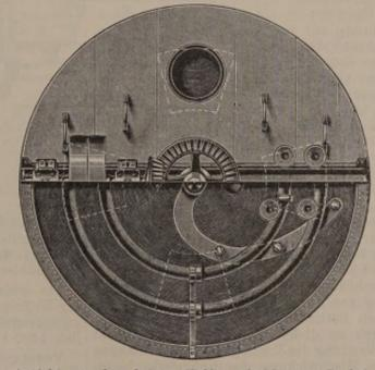
Ansicht von oben, bei zur Hälfte aufgeklapptem Deckel. Abb. 599 u. 600. Vormaischbottich mit Stabrührwerk.
