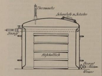
Abb. 603. Wärmeschutzmantel für Hefengefäße.
