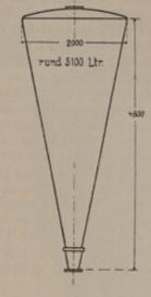
Abb. 102. Älteste Form des "Henze" mit kurzer stumpfer Spitze.
