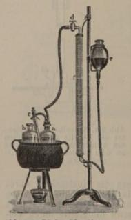
Abb. 202. Gärkraftbestimmungsapparat nach M. Hayduck.
