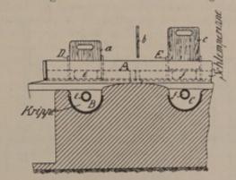
Abb. 496. Querschnitt durch die Krippen B c C während der Befüllung der Krippe C.
