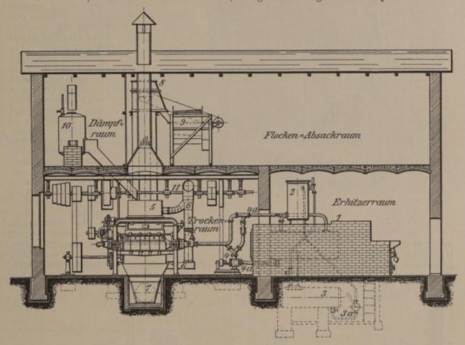
Abb. 295. Trockenanlage für Ölheizung.
