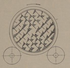
Abb. 243. Trommeltrockner.
