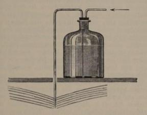
Abb. 232. Apparat zur Verteilung von Schwefel-kohlenstoff im Holzwerk eines Getreidesilos.
