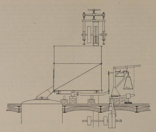
Abb. 302. Einfache Kartoffelwage mit Kartoffelvorratskasten und selbsttätiger Ausrückung des Vorgeleges für den Antrieb des Becherwerks und der Kartoffelwäsche.
