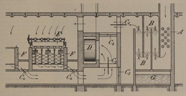
Abb. 413. Luftbefeuchtungsanlage für eine Kastenmälzerei.
