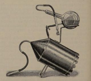
Abb. 276. Pasteurkolben und kupferner Reinzuchtkolben, beide in der von Henneberg angegebenen Form.
