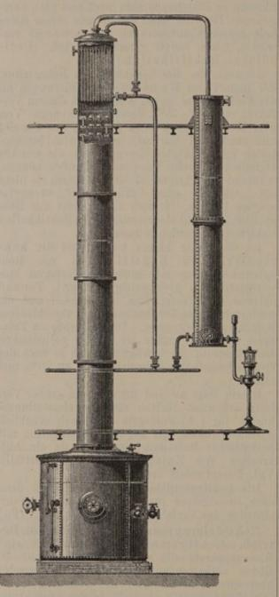
Abb. 453. Blasen-Rektifizierapparat für periodischen Betrieb
