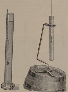
Abb. 16. Ungenaue An-zeige des Alkoholometers, welches den schief stehen-den Zylinder berührt.
