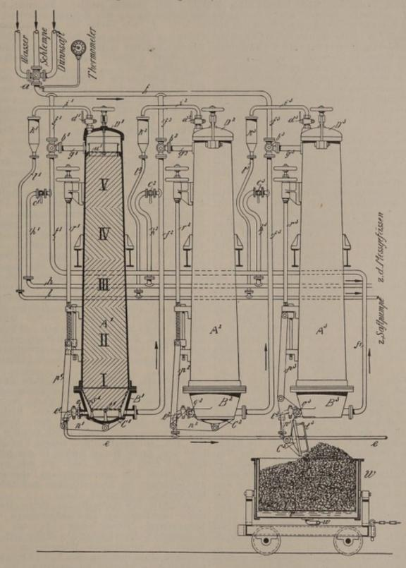
Abb. 471. Diffusionsanlage für Rübenbrennereien nach Guillaume, Egrot & Grangé.
