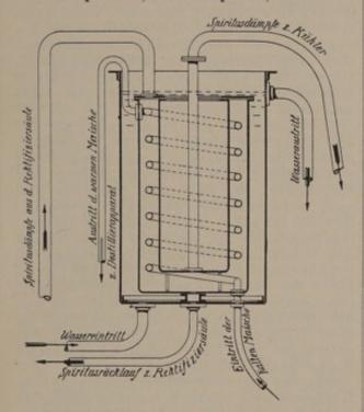
Abb. 320. Kondensator eines kontinuierlichen Maischedestillierapparats.
