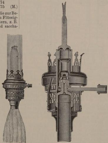
Außenansicht. Schnitt. Abb. 542 u. 543. Brenner für Tischlampen.
