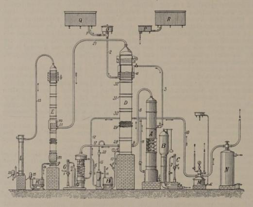
Abb. 330. Automatischer Destillier-Rektifizierapparat.
