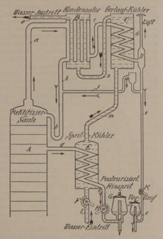
Abb. 400. Schematische Darstellung des Pasteurisierens von Sprit.
