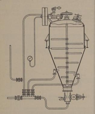
Abb. 109. Henzedämpfer mit Rührwerk.
