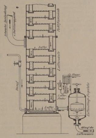
Abb. 353. Luttersäule eines zweiteiligen Destillierapparates mit Lutterwasserablaufregler und Lutterprober.
