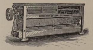
Abb. 361. Doppelsieb zur Trennung der zermahlenen Maiskeime und Sortierung der entkeimten Maisstücke.
