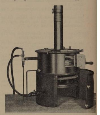
Abb. 587. Trockenschrank mit Thermoregulator und Glasabdeckung.
