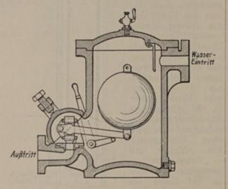
Abb. 125. Dampfwasserableiter (Kondenstopf) mit geschlossenem Schwimmer.
