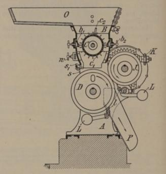
Abb. 375. Malzquetsche (Querschnitt).
