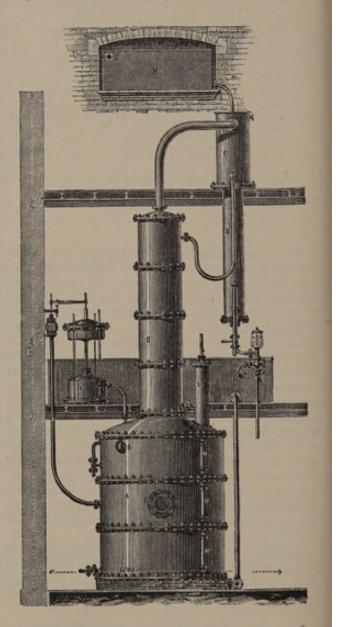
Abb. 454. Blasen-Rektifizierapparat für periodischen Betrieb
