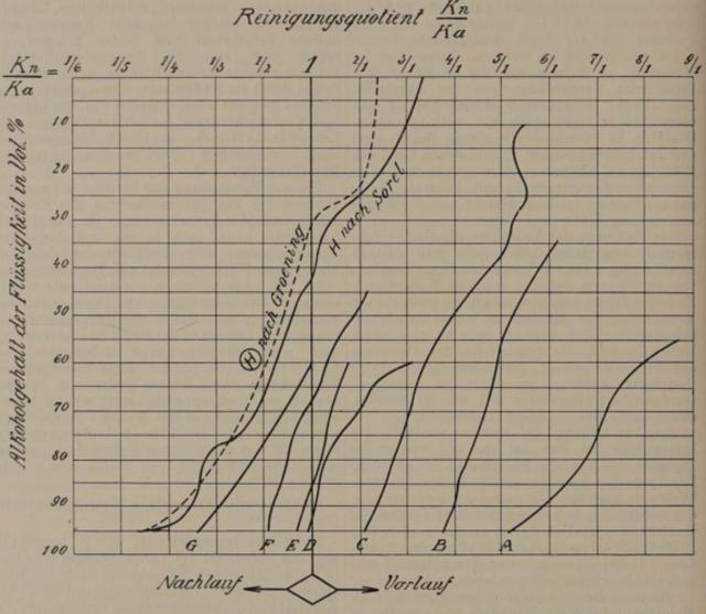
Abb. 452. Graphische Darstellung des Verhältnisses der Verdampfungsquotienten (Kn) der Nebenbestandteile des Rohspiritus zu den Verdampfungsquotienten (Ka) des reinen Äthylalkohols. A Ameisensäure-Äthylester, B Essigsäure-Methylester, C Essigsäure-Äthylester, D Isobuttersäure-Äthylester, E Isovaleriansäure-Athylester, F Essigsäure-Isoamylester, G Isovaleriansäure-Isoamylester, H u (H) Amylalkohol.
