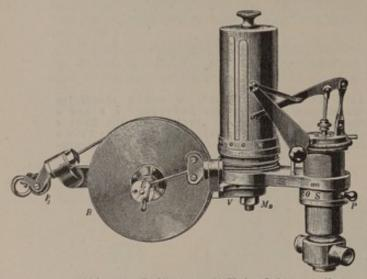
Abb. 270. Indikator mit Hubreduktionsrolle.
