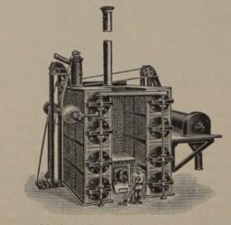
Abb. 298. Trommeltrockenapparat.
