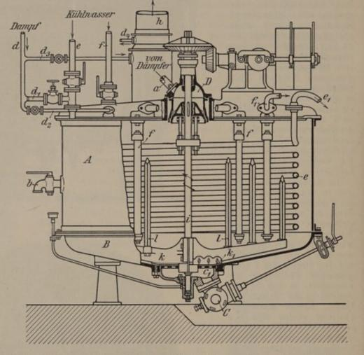
werks, sowie der Abb. 601. Vormaischbottich mit Maischmühle, Kühlschlange und senkrechten Kühlrohren.
