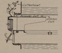
Abb. 165. Sekundärluftfeuerung.
