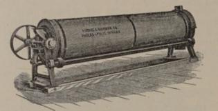
Abb. 360. Dampftrockner für entkeimten Mais.
