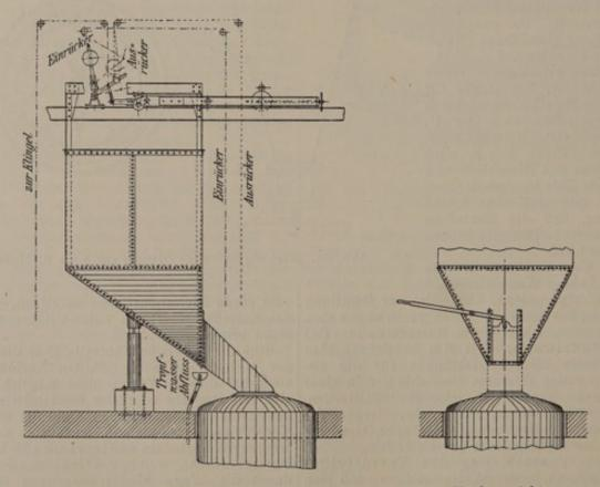
Seitenansicht. Vorderansicht. Abb. 303 u. 304. Einfache Kartoffelwage mit Kartoffelvorratskasten.
