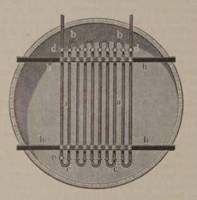
Abb. 191. Gärbottichkühler, aus parallel laufenden, geraden Rohren zusammengesetzt.
