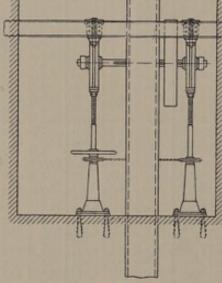
Seitenansicht. Vorderansicht. Abb. 54. Spannvorrichtung für die Kette eines Becherwerks.
