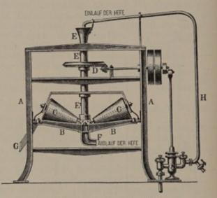
Abb. 263. Hefesiebmaschine.
