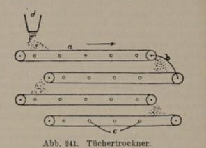
Getreide fällt auf der einen Seite durch einen Trichter d auf das Band, wird nach der andern Seite geführt und auf das darunter liegende Band befördert. Von
