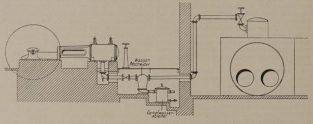
Abb. 96. Dampfentwässerung zwischen Dampfkessel und Dampfmaschine.
