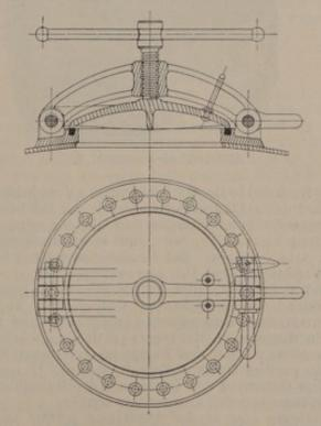
Abb. 106. Mannlochverschluß eines Henzedämpfers.
