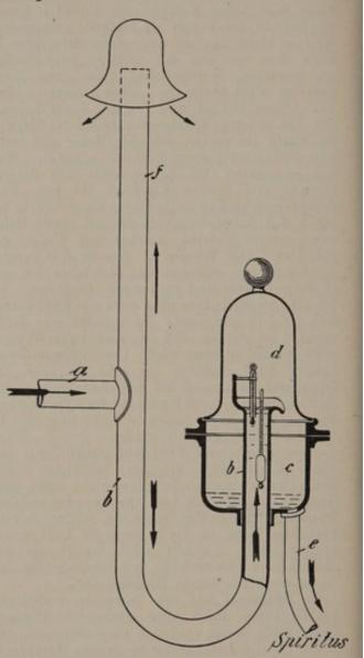
Einfache Spiritusvorlage eines Abb. 552. Destillierapparates.
