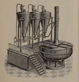
Abb. 98. Dämpferbatterie.
