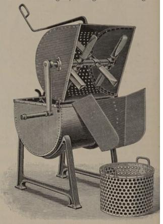
Abb. 300. Wasche zur Bestimmung des Schmutzgehalts in Kartoffelproben.
