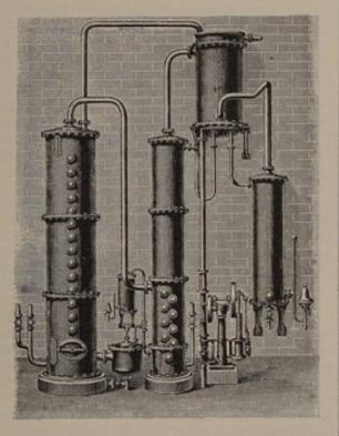
Abb. 327. Zweiteiliger kontinuierlicher Destillierapparat.
