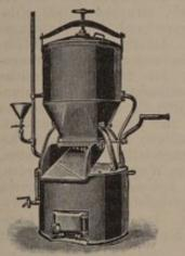
vorrichtung für das gedämpfte Futter versehen, teils zum Kippen eingerichtet und zuweilen auch mit ein Paar Walzen verbunden, mittels deren die gedämpften Futterstoffe bei der Entleerung des Dämpfers noch zerquetscht werden können (vgl. Abb. 186).
