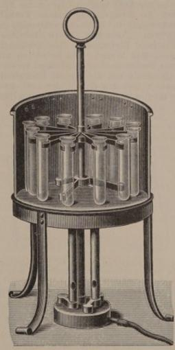
Abb. 617. Apparat zur maßanalytischen Zuckerbestimmung nach Reischauer.
