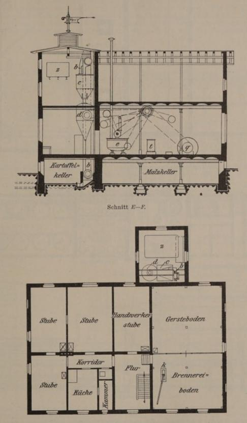
Grundriß des Obergeschosses. Abb. 66 u. 67. Entwurf für eine Kartoffelbrennerei.
