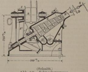
Abb. 141. Schneckenpresse.
