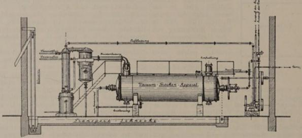
Abb. 594. Rotierender Vakuum-Trockenapparat.
