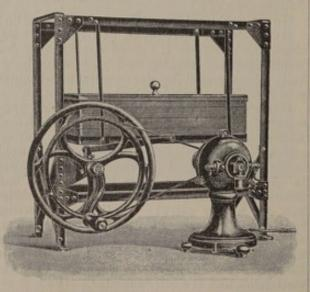
Abb. 234. Getreidesortiersieb zur Prüfung des Getreides auf gleichmäßige Korngröße.
