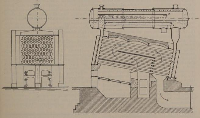
Abb, 115. Steinmüller-Kessel.
