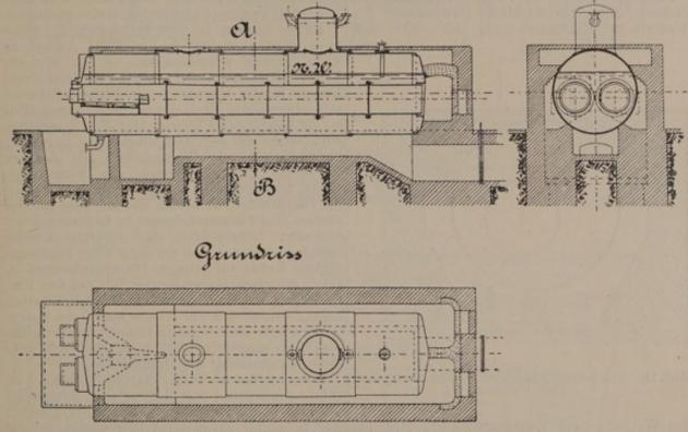
Abb. 112. Zweiflammrohrkessel mit geraden Flammrohren.
