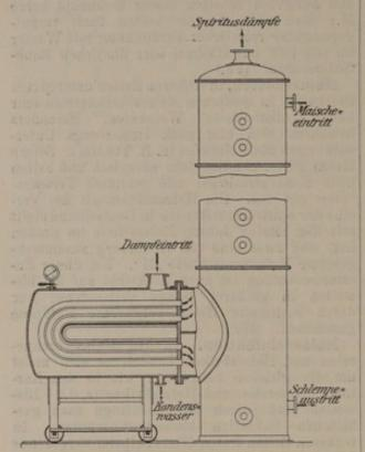
Abb. 377. Destillierapparat für Melassemaische mit Rapidverdampfer.
