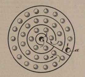
Abb. 323. Boden einer Maischedestilliersäule mit zahlreichen Glocken und kreisförmig angeordneten Zäunen, zwischen denen die zu entgeistende Flüssigkeit hindurchfließt.
