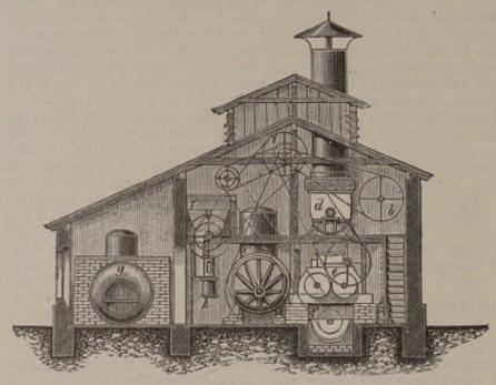
Abb. 493. Schlempetrockenanlage.
