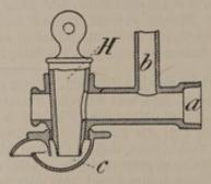
Abb. 344. Läuterhahn mit Siphonverschluß.
