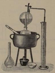
Abb. 203. Apparat zur Bestimmung der Gärkraft der Hefe (D. R. G. M.) nach der Vorder schrift des Instituts für Gärungsgewerbe.
