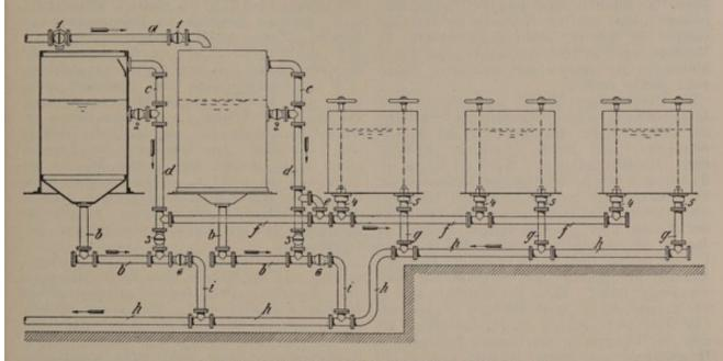
Abb. 204. Einrichtung für die kontinuierliche Gärung.
