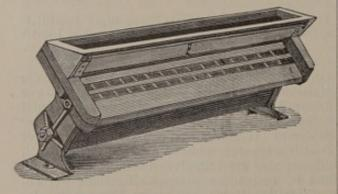
Abb. 354. Magnetapparat für Getreidereinigung.
