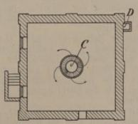
Abb. 127. Zweihordendarre mit direkter Heizung durch Feuergase.
