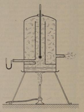
Abb. 578. Apparat zur Prüfung der Thermometer bei 100 °.
