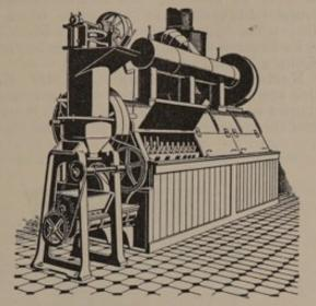
Abb. 299. Trommeltrockenapparat.
