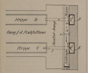
Abb. 495. Verteilung der Schlempe in die Krippen des Stalles. Nach Füllung der Krippe B ist der Schieber a geschlossen, der Schieber b geöffnet, der Schieber  $\sigma$  dagegen geöffnet und d geschlossen. Die Schlempe läuft bei dieser aus der Längsrinne A durch Kasten E in die Krippe C.
