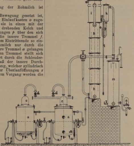
Abb. 583. Kontinuierlicher Destillierapparat.
