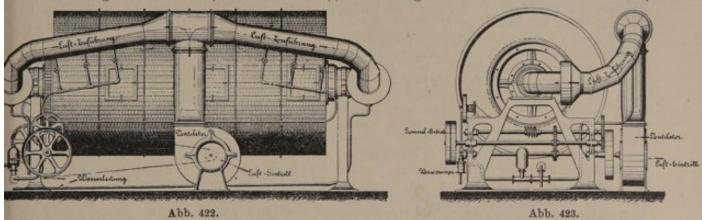
Ventilationseinrichtung der Mehrhaufen-Keimtrommel.
