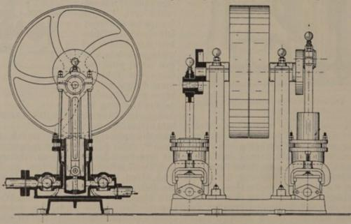
Abb. 442. Süßmaischpumpe in Zwillingsanordnung.
