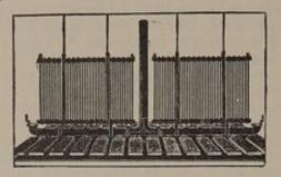
Abb. 351. Luftverteiler.
