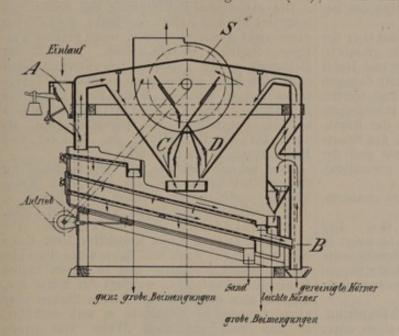
Abb. 228. Getreideputzmaschine mit Aspirator (S) und auswechselbaren Schüttelsieben.
