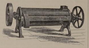
Abb. 359. Dämpfer zum Anfeuchten des zu entkeimenden Maises.
