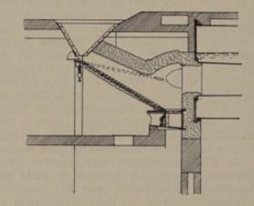
Abb. 163. Schüttrichter mit Treppenrost.
