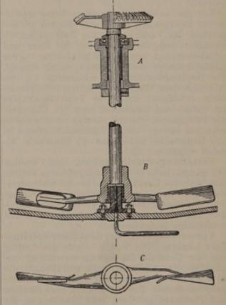
Abb. 598. Obere Aufhängung (A) und untere Führung (B) der Rührwelle eines neuzeitlichen Vormaischbottichs.
