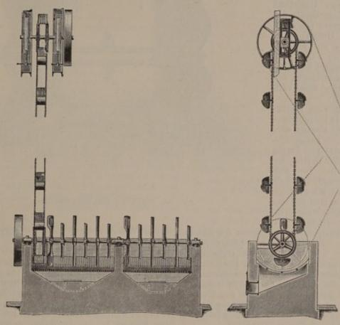
Vorderansicht. Seitenansicht. Abb. 55. Becherwerk in Verbindung mit einer Kartoffelwäsche,
