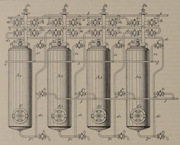
Abb. 317. Kohlenfilterbatterie.
