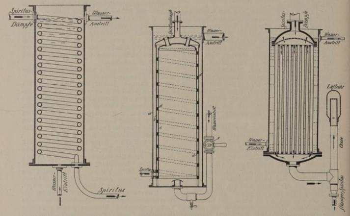
Abb. 546. Schlangenkühler für Destillier- und Rektifizierapparate.
