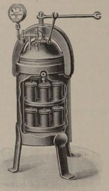
Abb. 560. Autoklav für die Stärkebestimmung.
