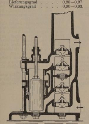
Abb. 438. Doppelwirkende Tauchkolbenpumpe.
