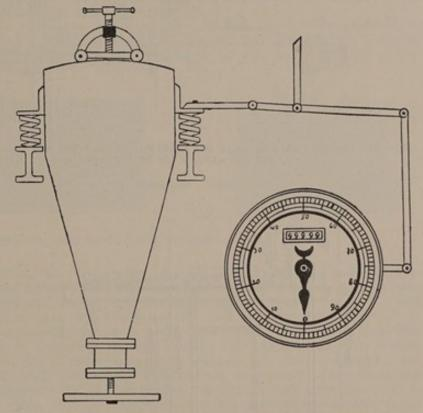
Abb. 301. Kartoffelfederwage (Henzewage) nach Slebioda.
