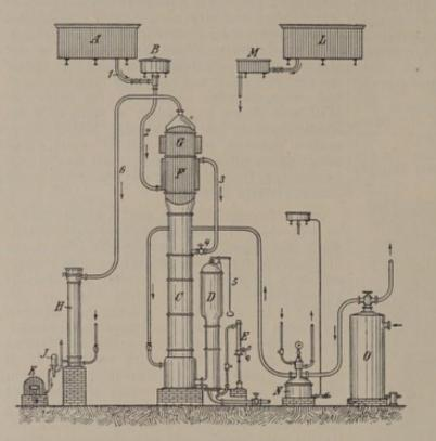
Abb. 328. Automatischer Destillierapparat.
