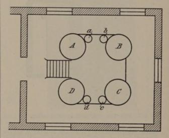
Abb. 194. Gärräum mit 4 aufrechtstehenden Gärkesseln A-D, die von einem gemeinsamen Podest bedient werden, auf dem die zugehörigen Kohlensäurewaschgefäße a-d stehen.
