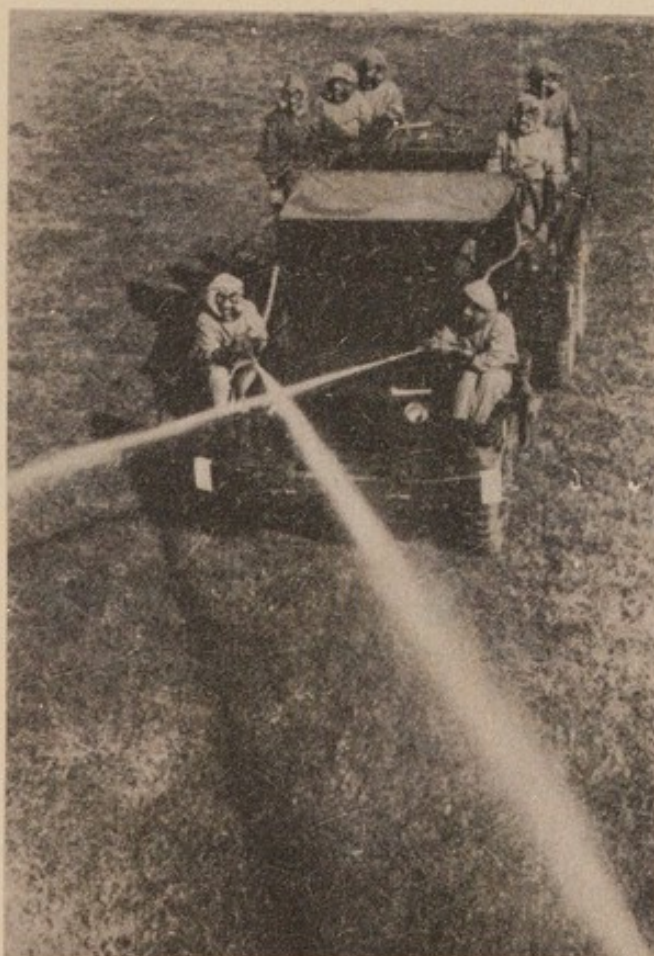
Figura 9. Descontaminación de la lechada de cloruro de cal.
