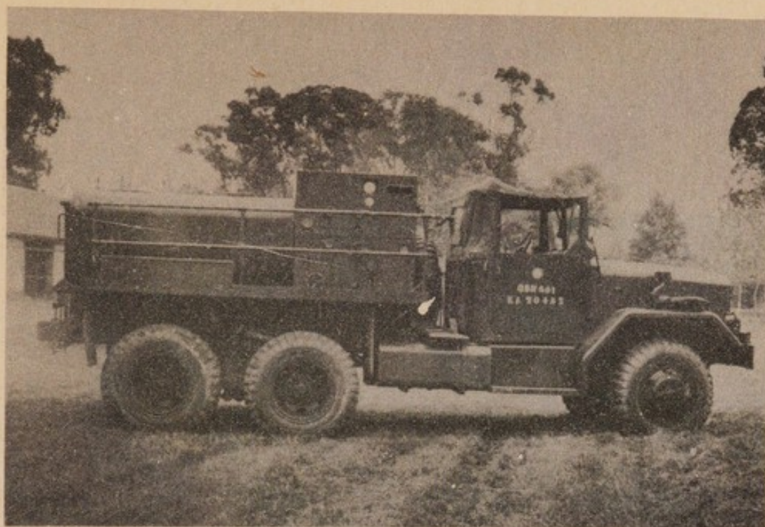
Figura 8. Aparato descontaminador de fuerza motriz (1.500 litros) sobre un camión.
