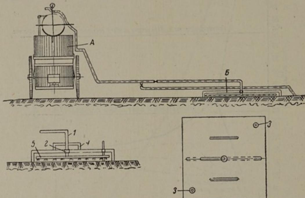
Рис. 3. Конная подвижная установка „АДУ“, смонтированная для обезвреживания почвы от яиц аскарид.
