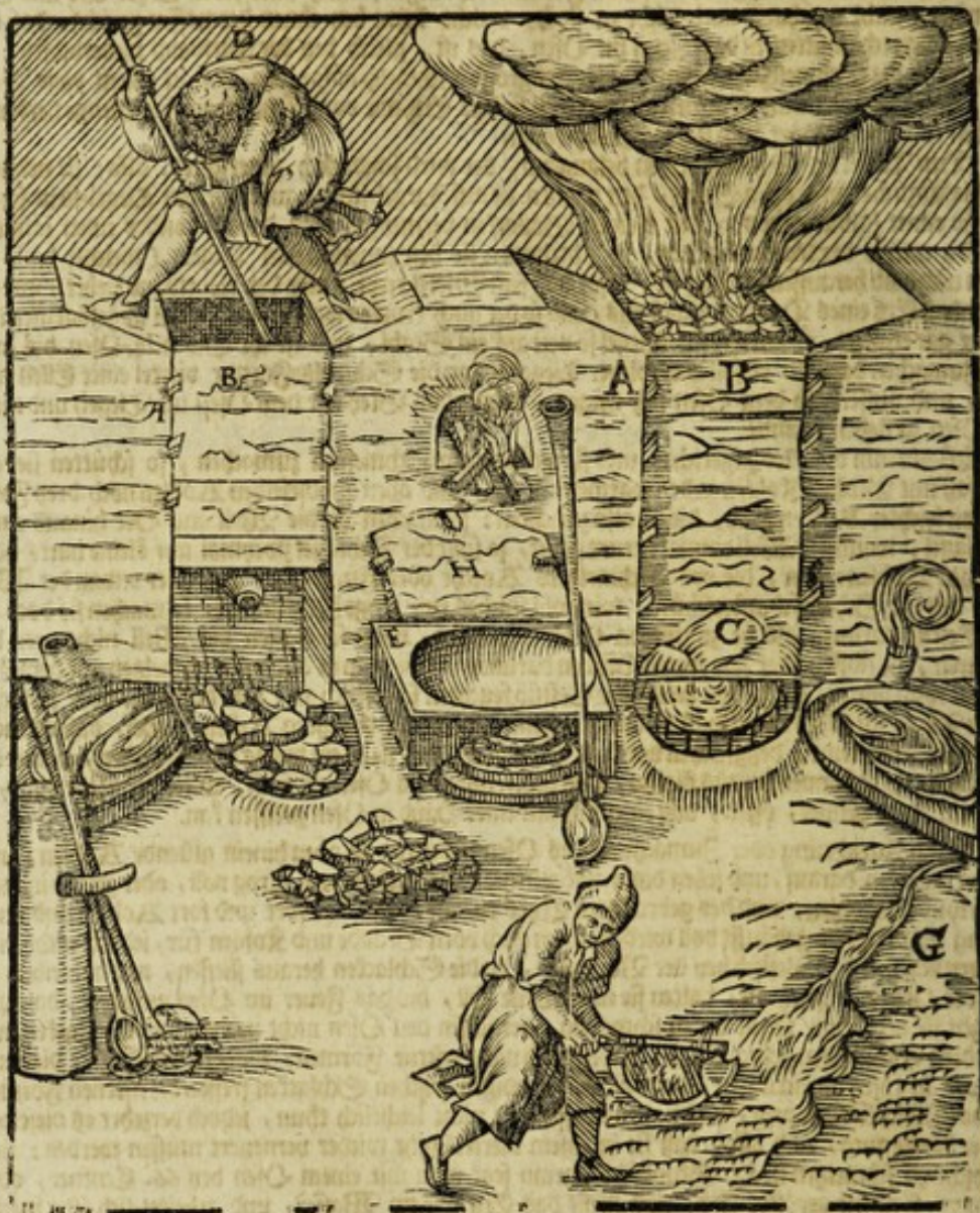
Der Ofen zum Anwärmen des Bley-Herds, A. Der Schmelz-Ofen und dessen Vordwand, B. Der Tiegel, welches Hellsie in den Ofen, die andere herausgehet, C. Der Schmelzer, D. Die Form zum Bley-Ausgießen, E. Die gerissene Bley-Scheiben, F. Die Schlacken, G. Der Bley-Herd, H.
