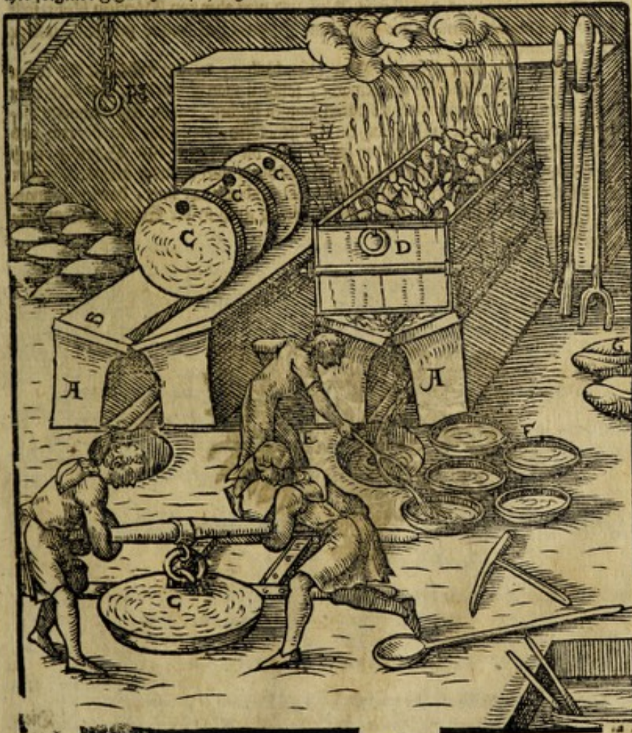
Die Seiger-Ofen, A. Die Seiger-scharten von Kupffern geseigert, B. die Seigerstück, C. Die Seigerwend, D. Der Seiger, E. Die Kupffern oder eiserne Pfännlein, F. Die Rinstöck, G. Der Zug, damit die seigerstück auf dem Seiger-Ofen gehoben werden, H.
