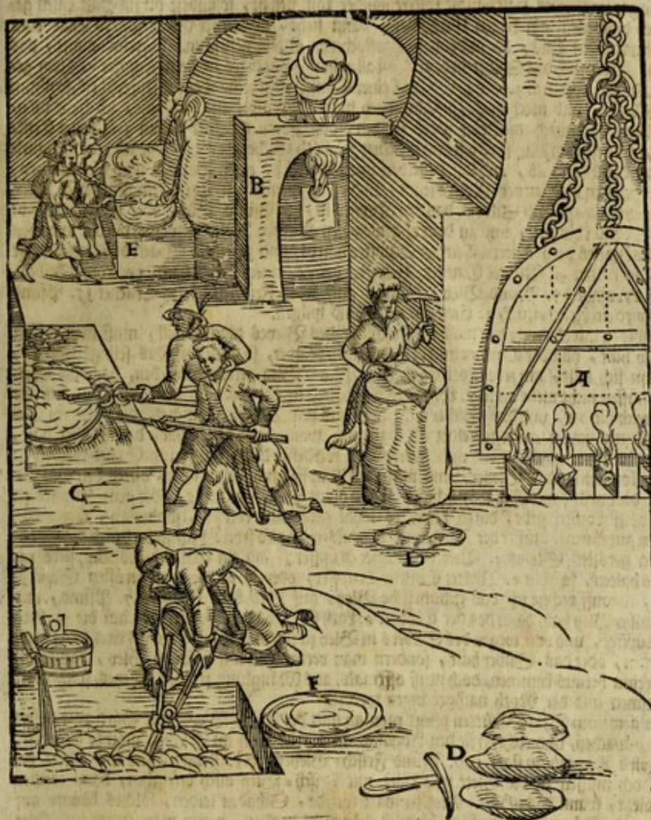
Der Dörr-Ofen, A. Der Gar-Ofen auf die Ungarische Art, B. Ein gemeiner Gar-Heerd, C. Die Rüststöß, so geblüet werden, D. Die Heerd zum Ungarische Spieß, E. Ein Kupfer-Schmelzen F. G.
