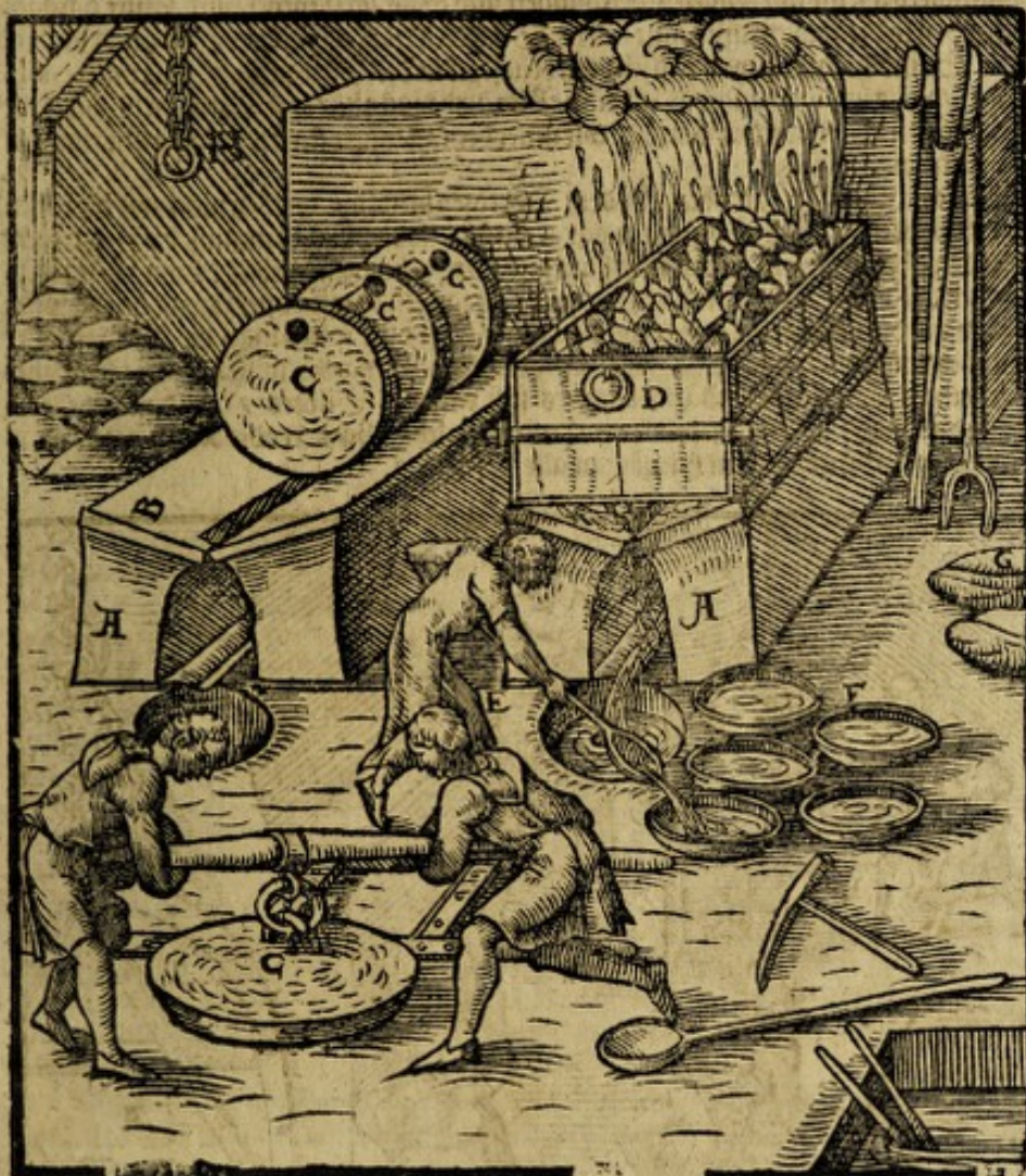
Die Seygeröfen / A. Die Seygerfcharten von Kupffer gegossen / B. Die Seygerfchart / C. Die Seygerfchart / D. Die Seygerfchart / E. Die Kupffer forn oder eiserne Pfannen lein / F. Die Rüstfack / G. Der Zug / damit die Seygerfchart auff den Seygeröfen gehoben werden / H.
