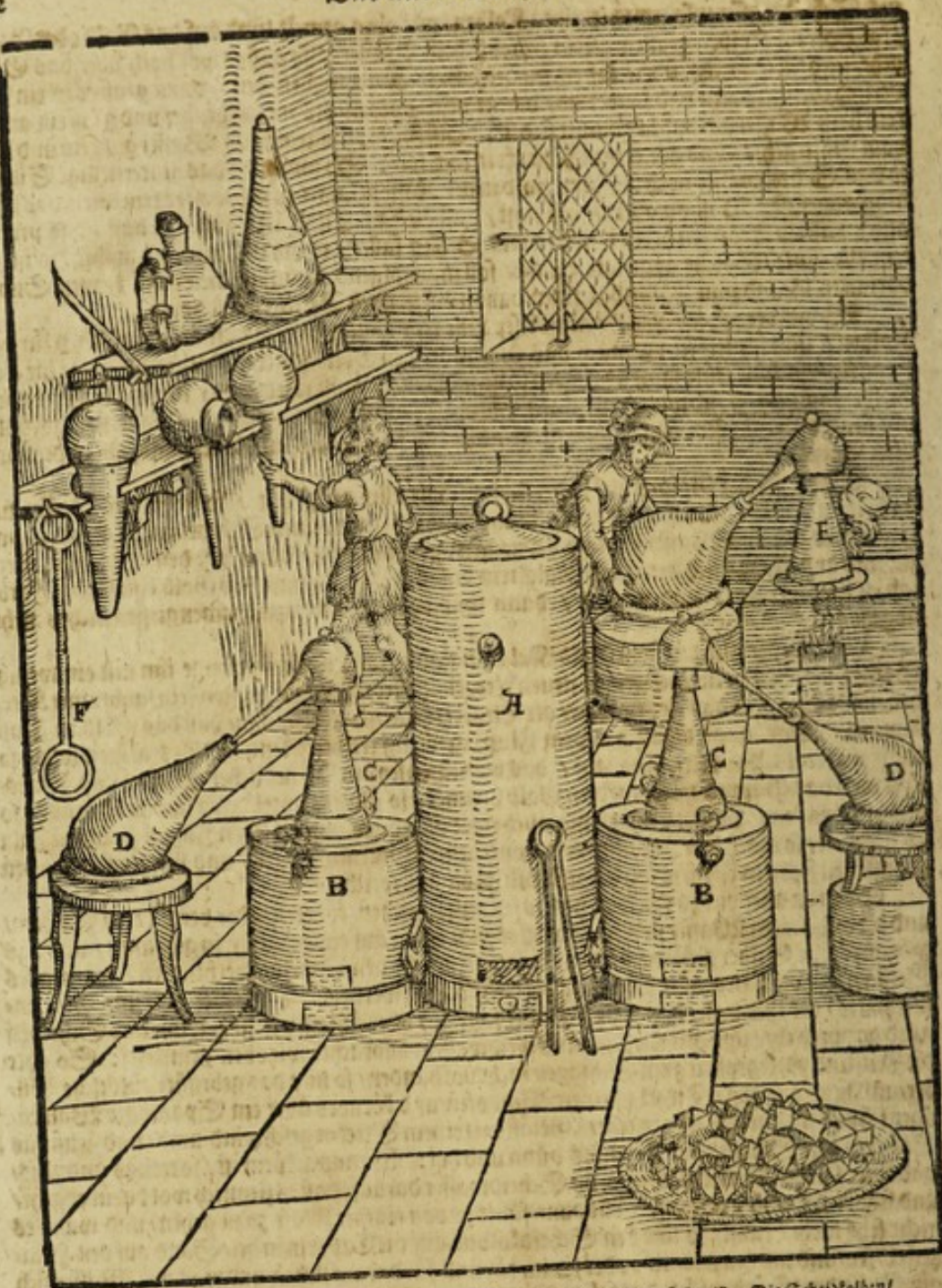
Der Feinhen-Thurn / A. Die Nebenöfen darinn die Capellen mit dem Sand stehen / B. Die Scheidkolben / darauf ein Helm stehet / C. Ein fürgelegter Kolben / D. Wie das Scheidwasser vom Silber gezogen wird / E. Ein eiserne Instrument / mit dem die Glascolben abgenommen werden / F.
