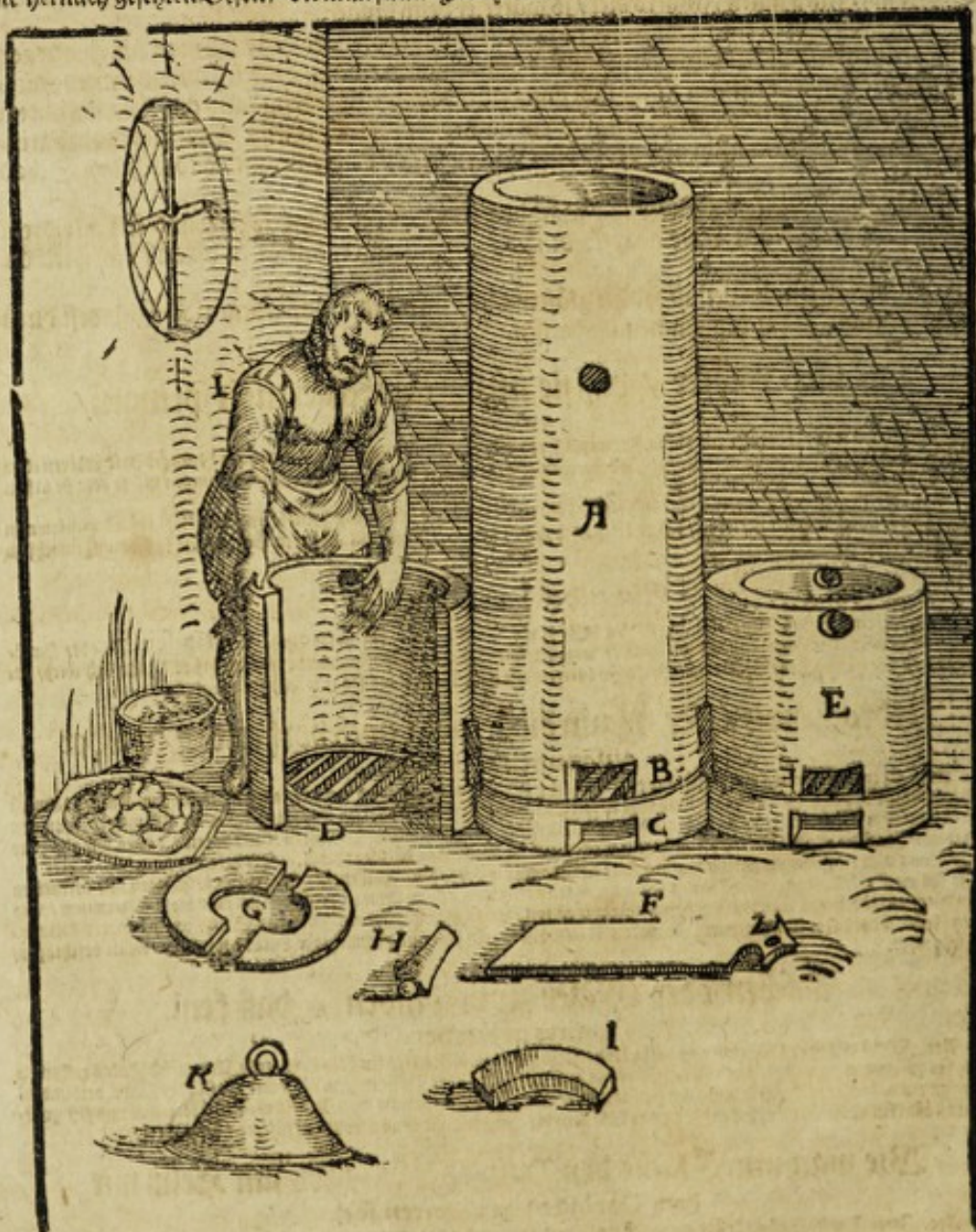
Der Heintzenbren / A. Das Rundloch über den Thalen / B. Das unter Rundloch / C. Der Koff in den Rebenofen / D. Der Rebenofen / E. Das Instrument zum fürschieben / F. Die Decken auß dem Rebenofen / G. Die Ventilköpff / H. Ein Stiel gel damit die Heintzen gemacht werden / I. Die Stürken auß den Heintzen / K. abgeriffen
