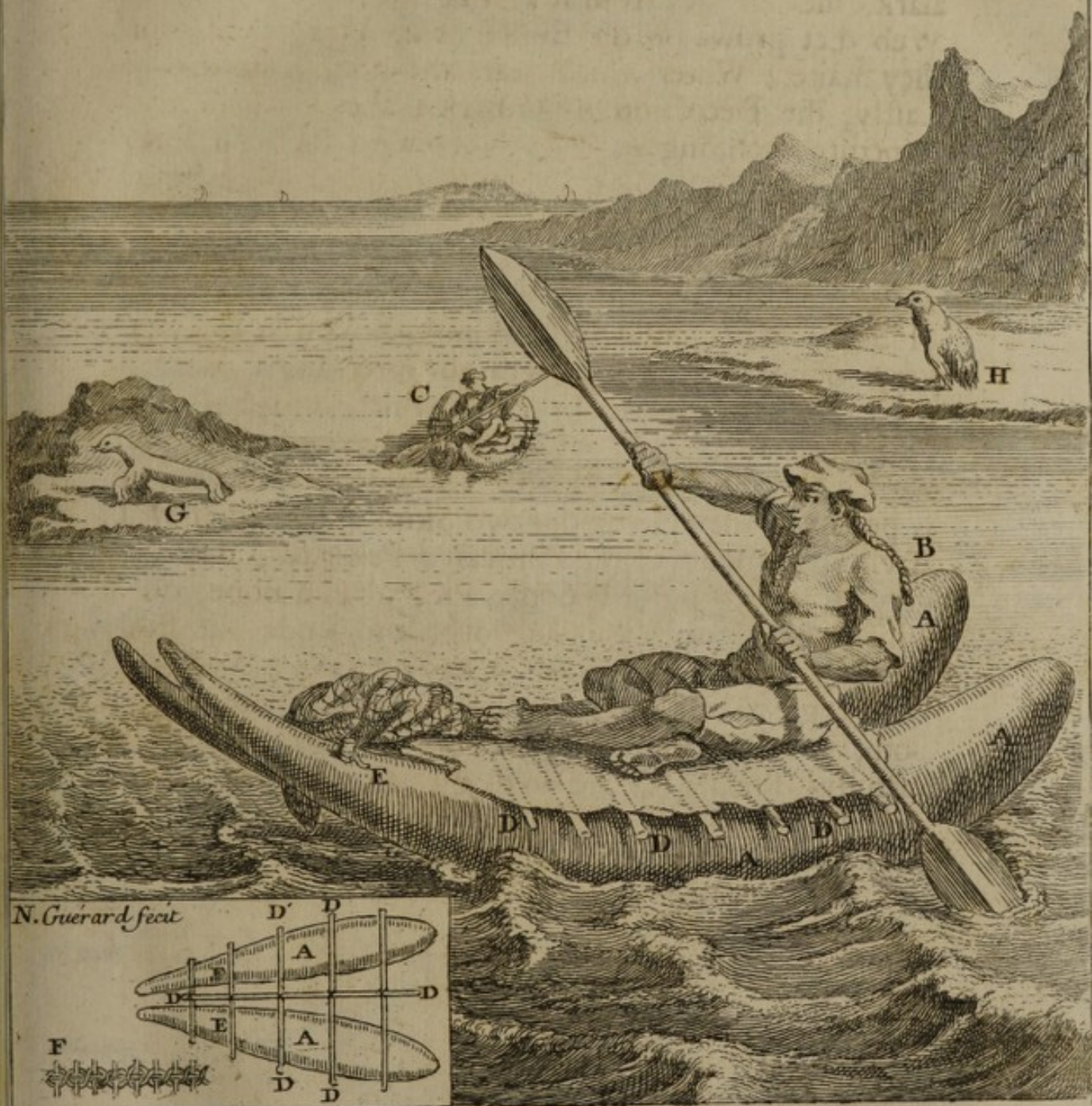
A. Plan d'une Basse faite de peaux de loups marins cousues et pleines d'air. B. Indien sur une Basse vue de Côté. C. autre vue de front D. Traverses pour rassembler les deux moitiés de la basse E trou pour l'enfler et la remplir d'air. F. manière de Coudre les peaux G. Loup marin a terre H Pinguin.
