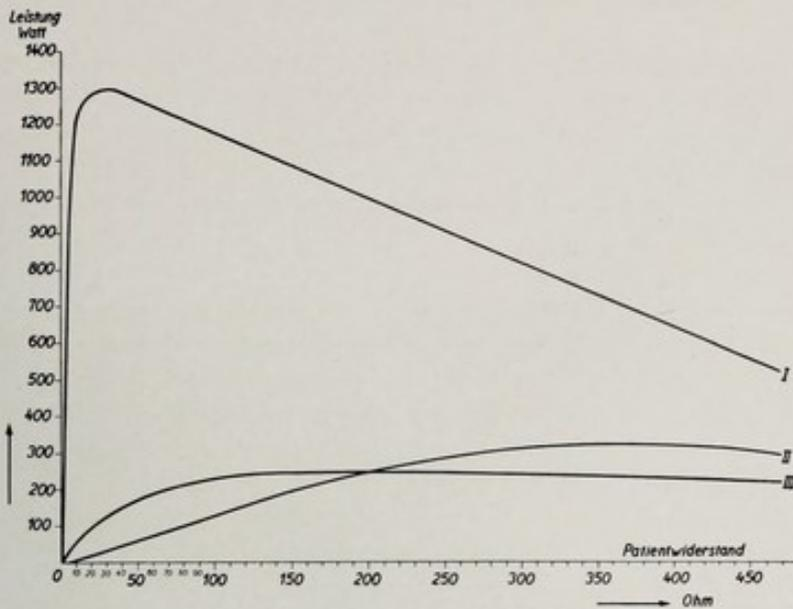
Abb. 34. Leistungskurven des Elchirapparates Penetrotherm-Duplex der Elektrizitäts-Gesellschaft „Sanitas“
