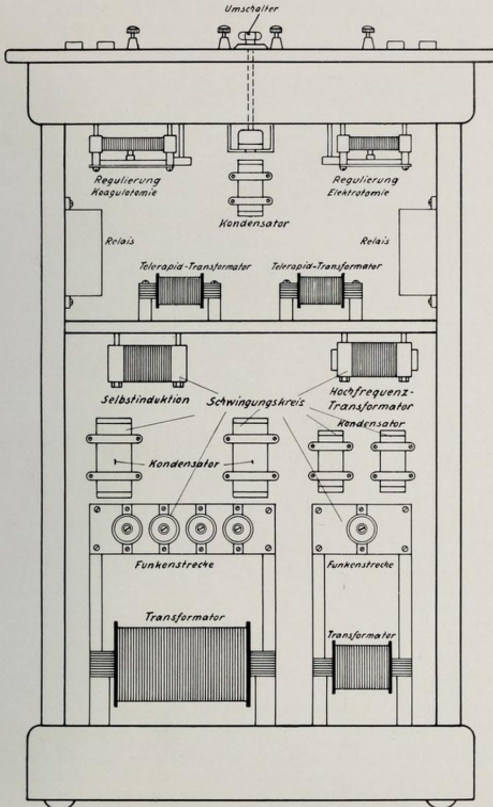
Abb. 5. Schema der Inneneinrichtung des Sanitas-Elektrotherm duplex.
