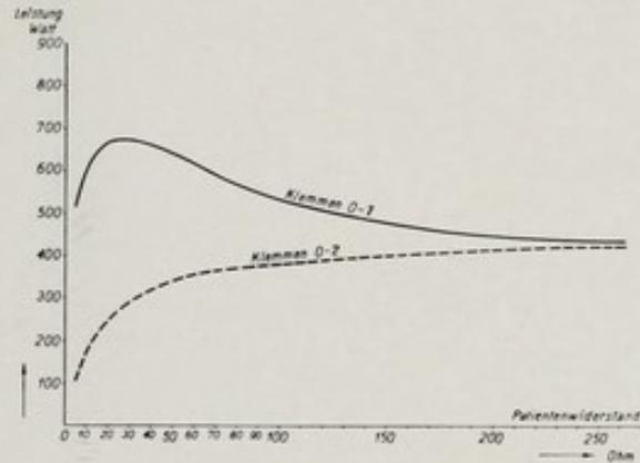
Abb. 36. Leistungskurven des Elchirapparates Thermoflux T (Siemens) bei Frequenzschalterstellung II. Wellenlänge des Hochfrequenzstromes etwa 250 m.
