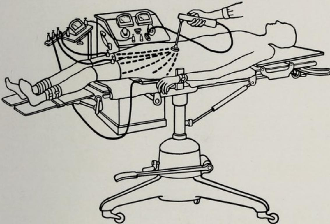
Abb. 4. Verlauf der Stromlinien über das zwischengeschaltete Zusatzamperemeter.
