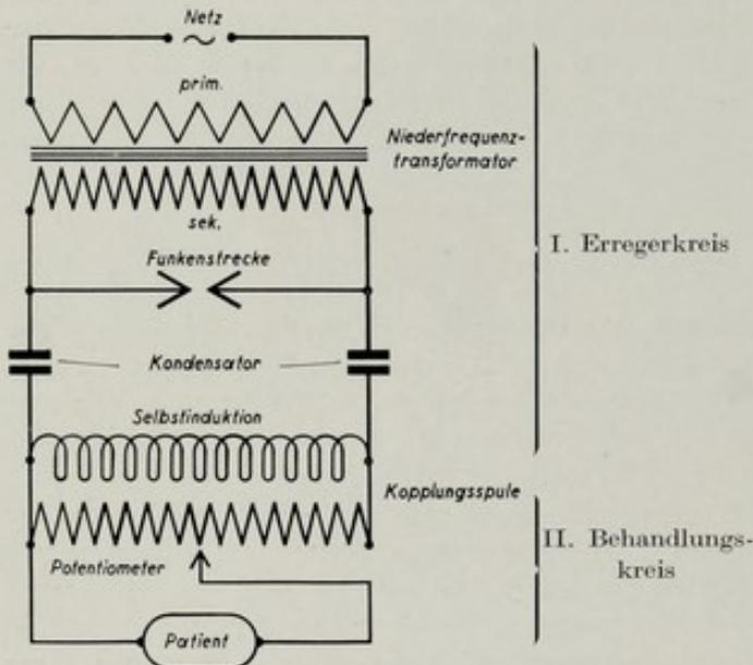
Abb. 1. Prinzipschaltung eines Diathermieapparates mit galvanischer Kopplung.
