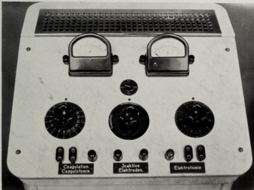
Abb. 9. Schalttafel des Sanitas-Elchirapparates.
