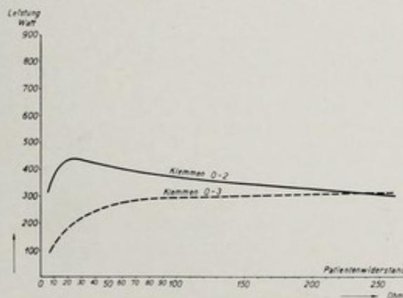
Abb. 37. Leistungskurven des Elchirapparates Thermoflux T (Siemens) bei Frequenzschalterstellung III. (2 Funkenstreckenpaare kurz geschlossen, erhöhte Funkenzahl) Wellenlänge des Hochfrequenzstromes etwa 250 m.
