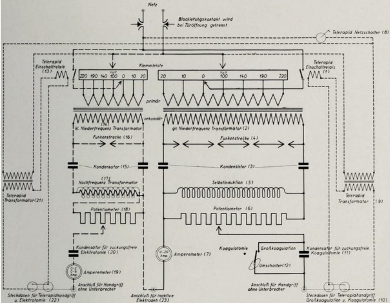
Abb. 6. Prinzipschaltbild des Penetrotherm duplex Elchirapparates der Elektrizitätsgesellschaft „Sanitas“.
