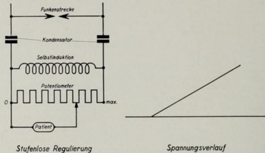
Abb. 2. Spannungsverlauf bei stufenloser Regulierung.
