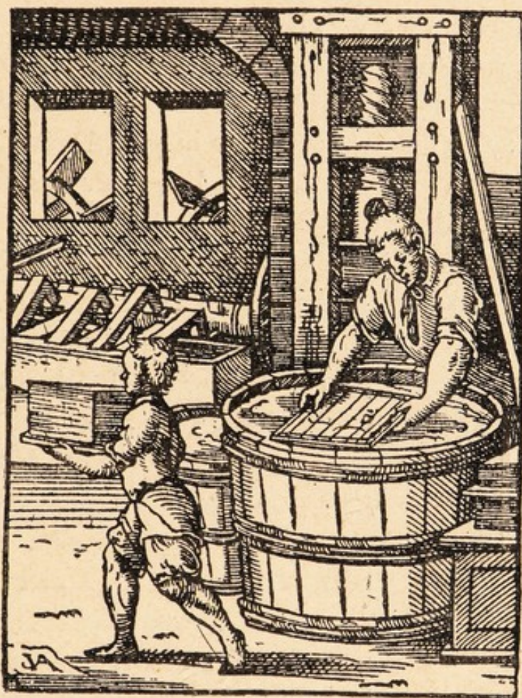
Fig. 91. — Fabrication du papier. Ouvrier travaillant dans la cuve avec le châssis à vergeures. Gravure de Jost Amman.
