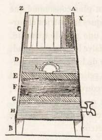
A B vase en bois, en tôle, etc. On peut le remplacer par une vieille futaille, qu'on divise intérieurement en compartiments.
