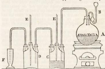
sel commun et le peroxide de manganèse dans le ballon A, on le bouche et on le fait chauffer doucement en introduisant de temps en temps de l'acide sulfurique par le tube de sùreté B. Deux flacons C et D sont disposés de telle sorte que le gaz y passe successive-ment; il se lave
