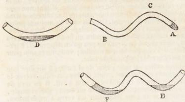
Je suppose que vous ayez à faire l'analyse d'une substance en très-petite quantité; vous vous servirez d'un tube semblable au tube ACB. La substance est placée au point A. Les parties volatiles se su-
