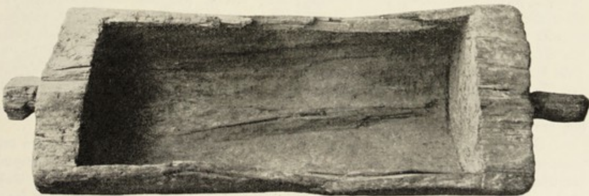
Abb. 316. Hölzerner Schwingtrog zum Waschen der Erze aus den Kupfergruben von Mitterberg. (Länge 1,20 m.) Originalmitteilung von Prof. D. Klose, Städtisches Museum Salzburg.
