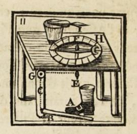
Le Faiseur de Tours avec son pied A, poussée la bascule B; par ce moyen il tire le fil C, à l'aide de la poulie G, il fait tourner l'axe E F sur lequel le fil est entortillé; par ce moyen l'aiman H, tourne autour de son pivot, comme l'aiguille d'une montre, & quand il arrive sous le canif I, dont la lame est en dehors, il lui fait faire la culbute par son attraction.
