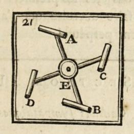
la balle D, plus éloignée du point d'appui que la balle C, tend encore à l'emporter; mais la balle B, qui, dans ce moment, est plus loin du point d'appui que la balle A, tend à faire tourner la machine en sens contraire. Ces deux efforts opposés doivent donc
