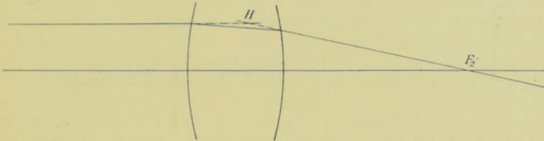
Fig. 54. Brechung eines zur Achse parallelen Lichtstrahles durch eine Sammellinse.
