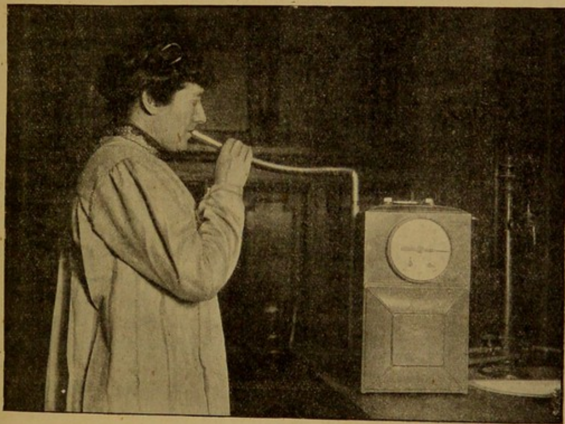
FIG. 8. — Spiromètre servant à mesurer la capacité vitale V.
