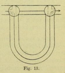
braucht, um sie zu durchlaufen, wird die Geschwindigkeit bestimmt. 2. Ludwig's Stromuhr lässt wiederholte Messung nach ähnlichem Prinzip zu. 3. Vierordt's Hämotachometer. Ein Strompendel in einem Messingkästchen wird proportional der Schnelligkeit des Blutstromes abgelenkt; der Apparat muss empirisch geeicht werden.
