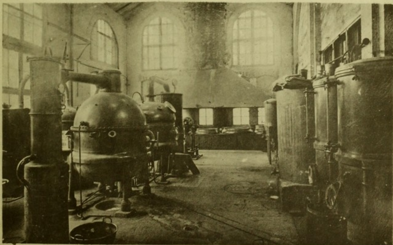
Fabrication des Extraits (Appareils à évaporer dans le vide)
