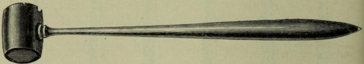
Fig. 121. Handhammer zum Condensieren des Goldes.
