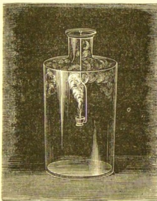
Fig. 15. Combustion du sodium dans le chlore.
