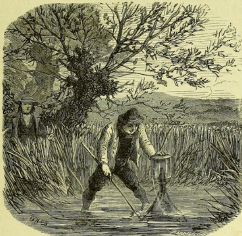
Gaz des marais (hydrogène protocarbure) recueilli dans un flacon.
