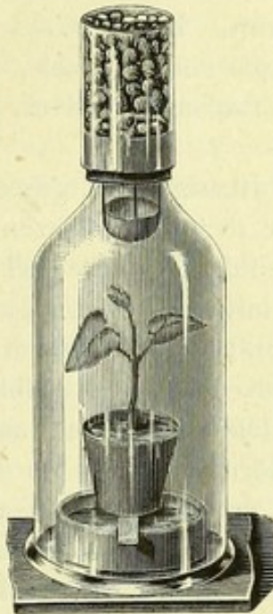
Apparat zu Culturversuchen in kohlenstofffreier Luft nach Pfeffer.
