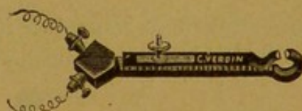
Fig. 360. — Excitateur à verrou de M. le professeur Dastre. (Exposition Verdin.)
