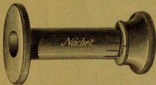
Fig. 271. — Petit Microtome à main (Exposition Nachet).
