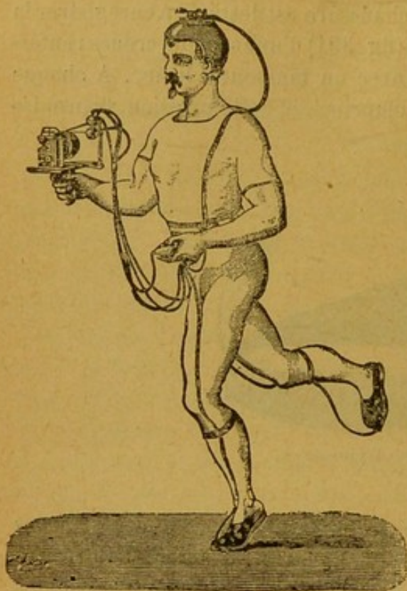
Fig. 393. — Coureur armé de chaussures exploratrices et d'un explorateur des réactions verticales, tenant à la main un cylindre enregistreur portatif. (Professeur Marey.)
