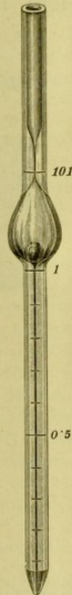
Capillarrohr zum Blutkörperchen-Zählapparate von Thoma-Zeiss .
