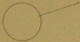
Abb. 18. Platinscheibchen mit angeschweißtem Platindräht.
