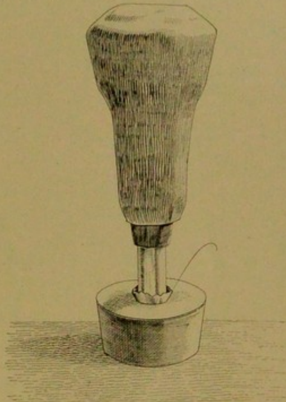
Abb. 20. Das flache Platinsieb wird zu einem Platinschälchen gepreßt.
