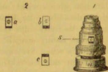
Fig. 40. Linsensystem mit Korrektionsapparat. (Der Metallschieber s bei 1 zeigt die Stellungsveränderungen der Linsen an, wie 2 a b c versinnlichen).
