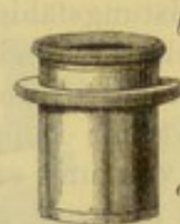
Fig. 56. Polarisator. Die Röhre a in den Tisch eingepasst; b Sammellinse aus Flintglas.
