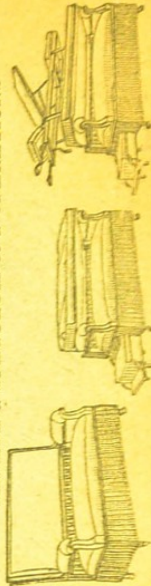
Cuvette rentrée. Système du Docteur APOSTOLI, de Paris. Cuvette avec tube plongeur pour lavages. Élévation du bassin par manivelle.
