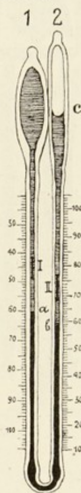
Fig. 9. Maximum- und Minimumthermometer nach Six für Tiefseegebrauch von L. Casella in London. (Nach Krümmel.)
