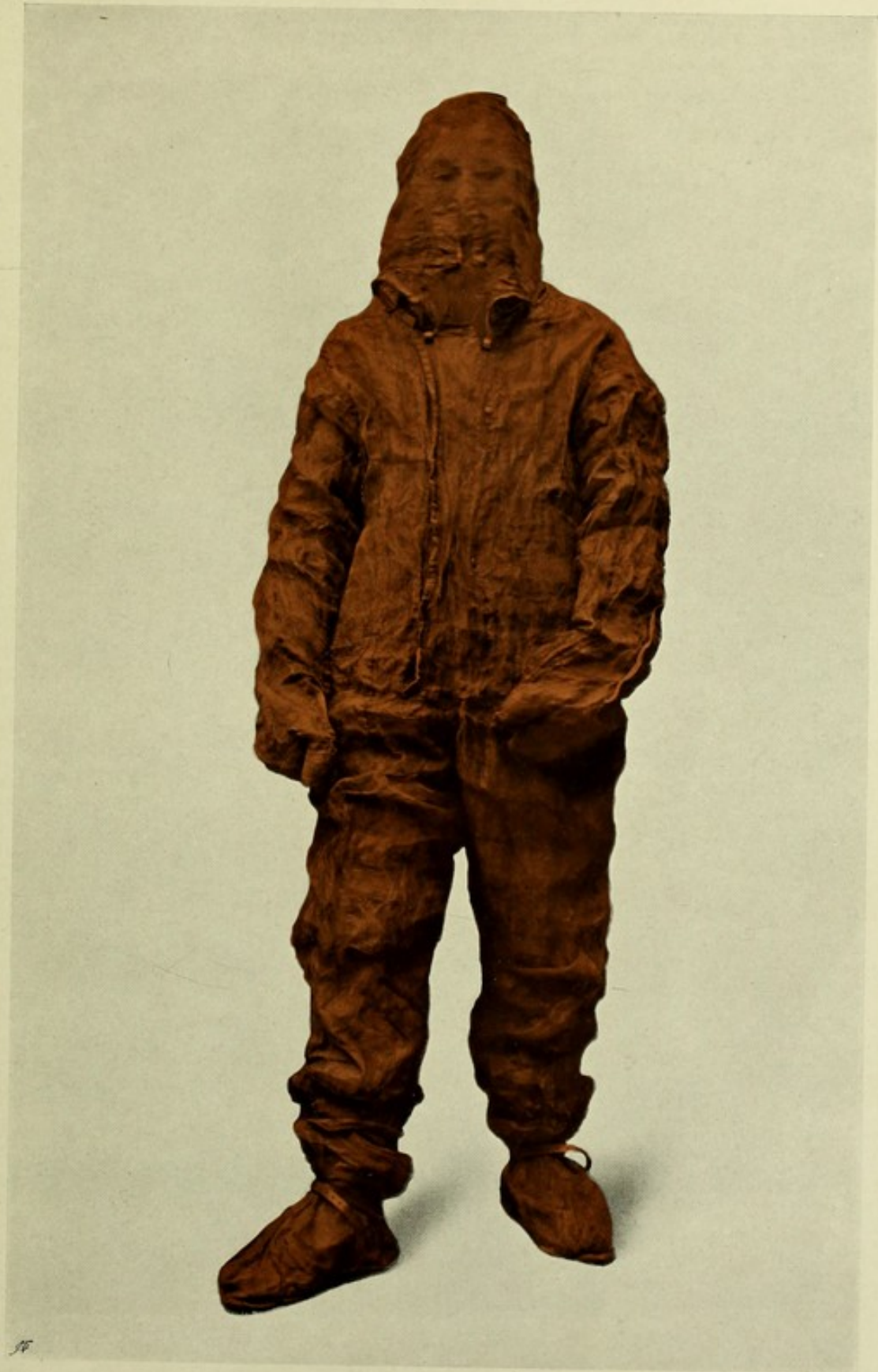
Fig. 176. Schutzanzug aus feinem Kupferdraht (für Arbeiter in Hochspannungsräumen).
