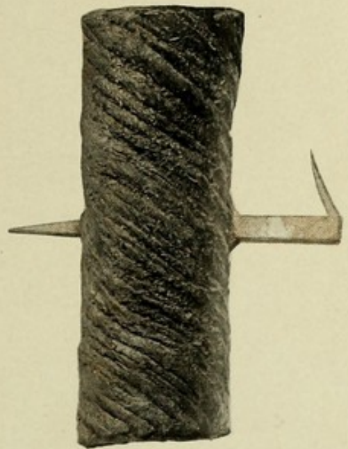
Fig. 158. Kabel durchgenagelt, ohne Betriebsstörung.
