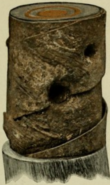
Fig. 157. Zweimal angehacktes (2 Löcher) Straßenkabel (durch Hiebe mit Erdhaue).
