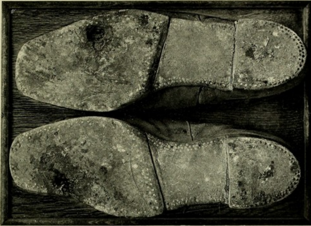
Fig. 84. Durchlöcherung und Verkohlung der Schuhsohlen (Stromaustritt).
