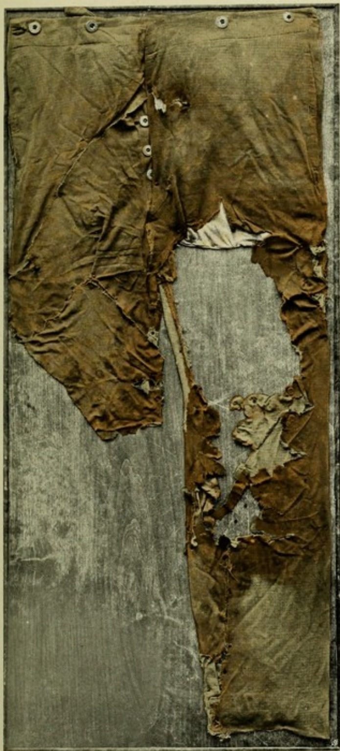
Fig. 23. Zerstörung des Beinkleides durch den Stromübergang (stellenweise bräunliche Metallimprägnierung).
