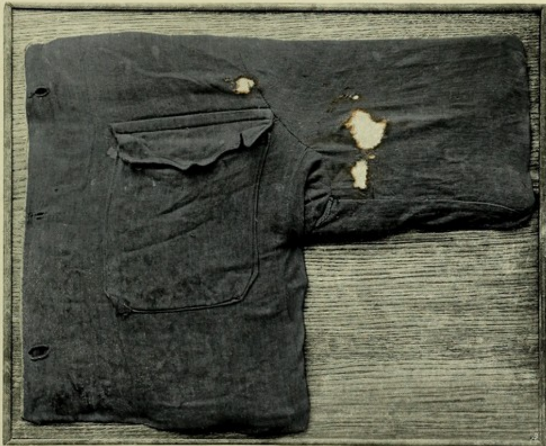
Fig. 111. Ärmel der Arbeitsbluse, durchlöchert und spurweise angesengt.
