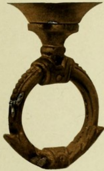
Fig. 202b. Mehrere kleine Schmelzungsspuren am unteren Ring.
