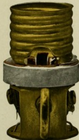
Fig. 86. Zerstörung der Lampenfassung (Metallperlen).
