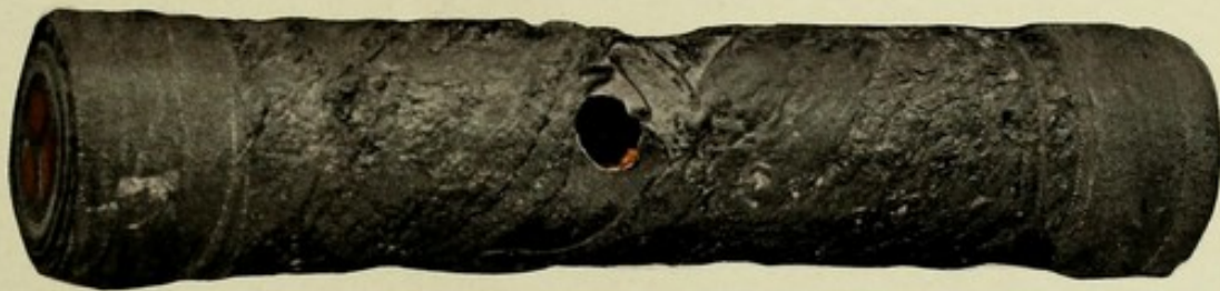
Fig. 165. Drehstromkabel, 3 \times 50 \text{ mm}^2 Querschnitt und 2000 Volt Betriebsspannung. Durchschlag infolge Eindringens von Feuchtigkeit.
