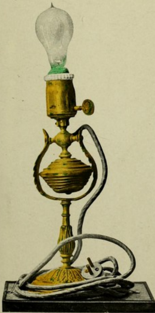
Fig. 29. Der Metallsockel der Lampe durch Stromübergang beschädigt (aboxydiert).
