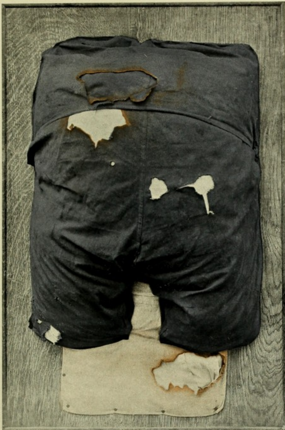
Fig. 131. Durchlöcherung, stellenweise Versengung der Bluse, des Beinkleides und des Unterbeinkleides durch Berührung mit schlecht isoliertem Kabel.
