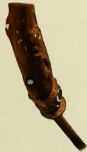
Fig. 202a. Mehrere kleine Schmelzungsspuren am Gestänge.
