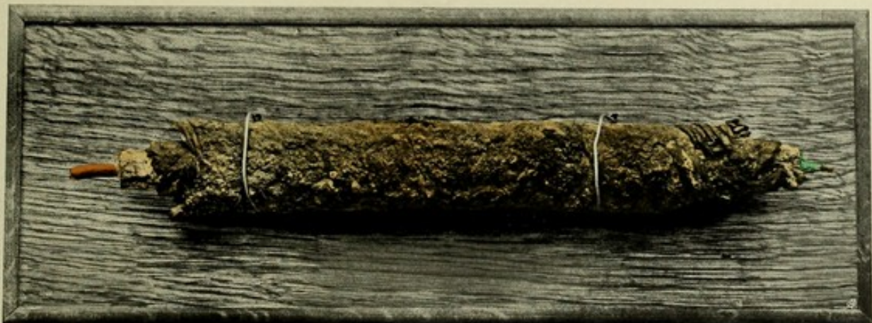
Fig. 170. Das rechte Ende des Kupferkabels verschmächtigt und mit grünlichem Beschlag (aboxydiert).
