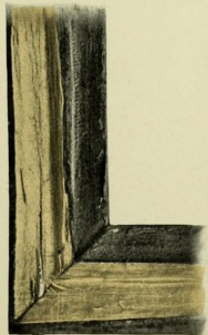
Fig. 212a. Der eiserne Nagel im Rahmenwinkel mit Schmelzungsspuren.
