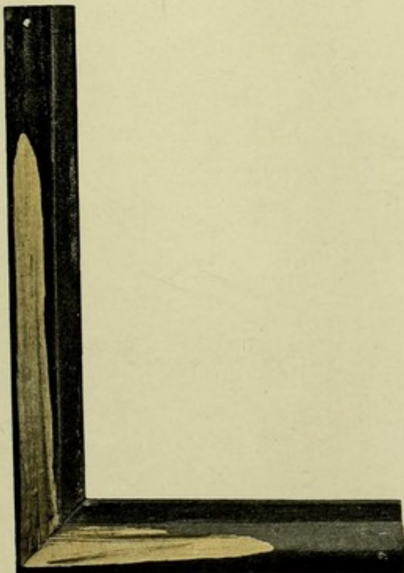
Fig. 212. Zersplitterung eines Bilderrahmens.
