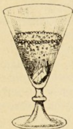
FIG. 196. — Un bâton de craie est violemment attaqué par l'acide chlorhydrique, en dégageant du gaz carbonique.
