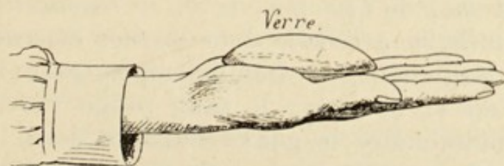
FIG. 45. — Le verre de montre, mouillé d'eau de baryte et appliqué contre la main, blanchit par suite de la formation de carbonate de baryum, due au dégagement de \text{CO}_2 par la peau.
