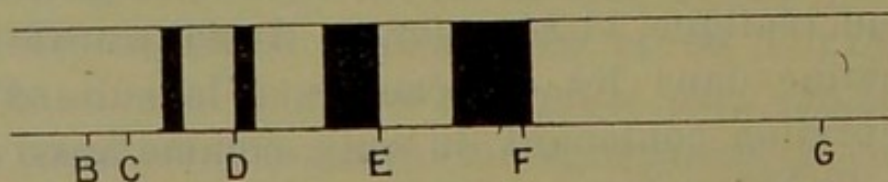
Fig. 9 . — Spectre d'absorption des solutions acides d'hématine.
