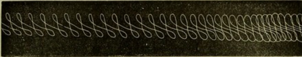
Fig. 76. — Graphique d'une verge de Wheatstone accordée à l'octave, c'est-à-dire vibrant deux fois transversalement pour chaque vibration longitudinale (figure empruntée à R. Koenig). Le ralentissement du cylindre produit la condensation des courbes vers la fin du graphique.
