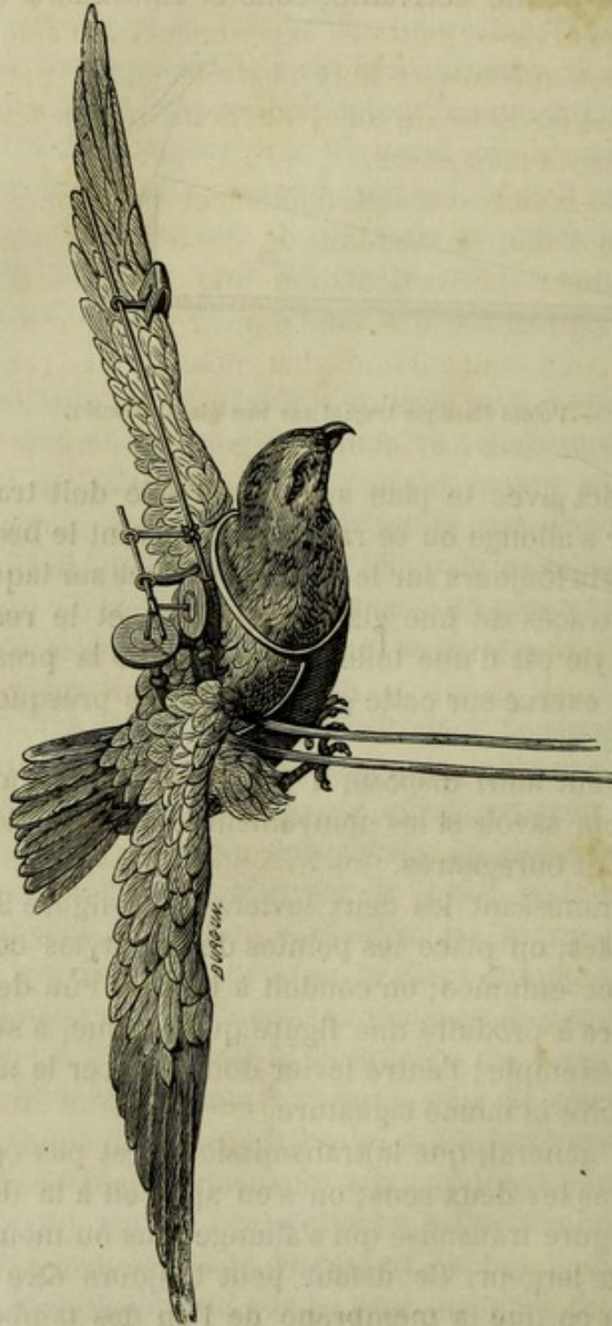
Fig. 99. — Buse volant avec l'appareil qui signale les mouvements décrits par l'extrémité de son aile.
