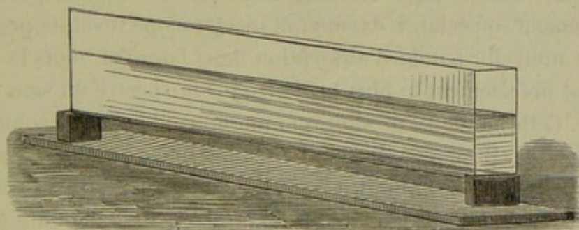
Fig. 12. — Cuvette de verre à parois verticales non parallèles, pour l'analyse spectroscopique.
