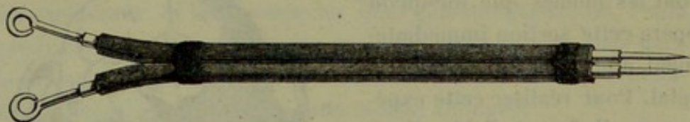
Fig. 47. — Excitateur. Les deux aiguilles sont en cuivre et leurs pointes en platine. Elles sont renfermées chacune dans une gaine de caoutchouc durcie et réunies par un fil de soie cirée.
