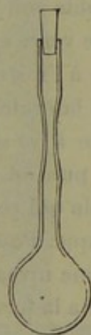
Fig. 176. — Flacon pour déterminer le poids spécifique de petites quantités de liquide.
