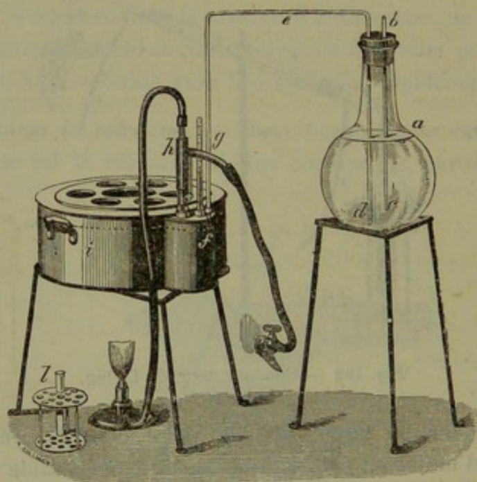
Fig. 163. — Bain-marie à température constante pour digestion ou évaporation. Le régulateur à gaz h n'est pas le même que celui qui est représenté figure 165. Il est plus coûteux et n'est pas préférable à ce dernier.
