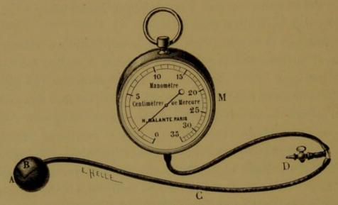
Fig. 1. - Sphygmomanomètre.
