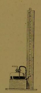
Fig. 2. — Manomètre à mercure pour la vérification du sphygmomanomètre.
