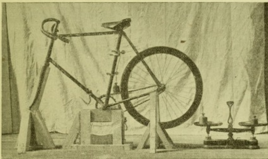
PLANCHE III. — Monocycle ergométrique.
