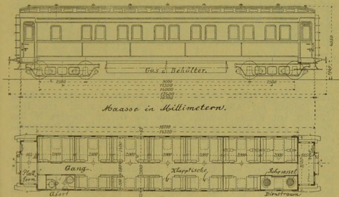
Fig. 8. 4-achsiger Drehgestellwagen mit mittlerem Durchgang.
