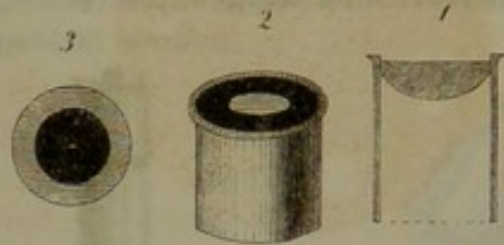
Fig. 20. Gewöhnlicher Kondensor; 1 im Durchschnitt; 2 mit einer Ringblende; 3 mit einer centralen.
