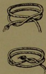
Fig. 77. Verknotung der Doppelsehne am oberen Ende des Tonkugelbogens.
