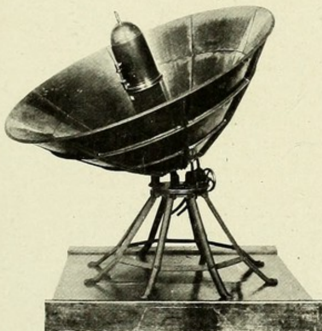
Fig. 8. — Appareil de MM. Mouchot et A. Pifre pour l'utilisation industrielle de la chaleur solaire (V. N° 9518.)
