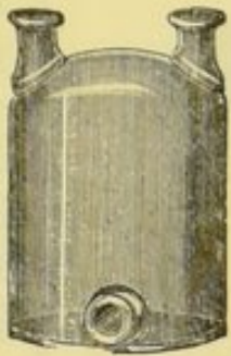
Abb. 88. Moderne Woulfische Flasche mit zwei Hälsen u. Tubulus am Boden.
