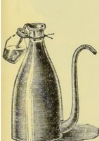
Abb. 55. Destillatio per filtrum an Florentiner Flasche.
