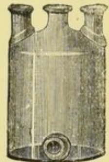
Abb. 89. Moderne Woulfische Flasche mit drei Hälsen u. Tubulus am Boden.
