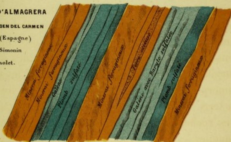
Fig. 3 COUPE GÉOLOGIQUE PASSANT PAR LA MINE DE L'ARTESICA entre Carthagène et le cap Palos (Espagne) dressée par M. Simonin d'après Pernolet.
