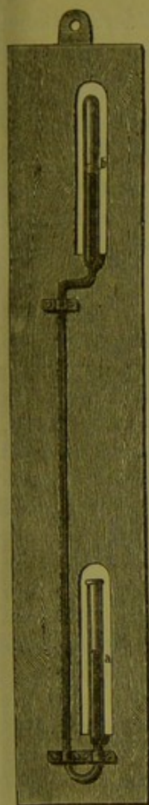
Heberbarometer mit festliegendem Rohr und fixer Scala.
