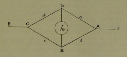
Un circuit métallique formé d'abord d'un fil unique EC, se bifurque; ses branches, après un trajet CD, CB, se replient et se rejoignent en A pour reconstituer le circuit unique AF. Le courant électrique entre dans le circuit par le fil EC, se bifurque, puiss retourne à la pile par le fil unique AF. Aux points d'intersection D et B sont insérés les deux conducteurs d'un galvanomètre, G. L'ensemble de ce schéma porte le nom de pont de Wheatstone.
