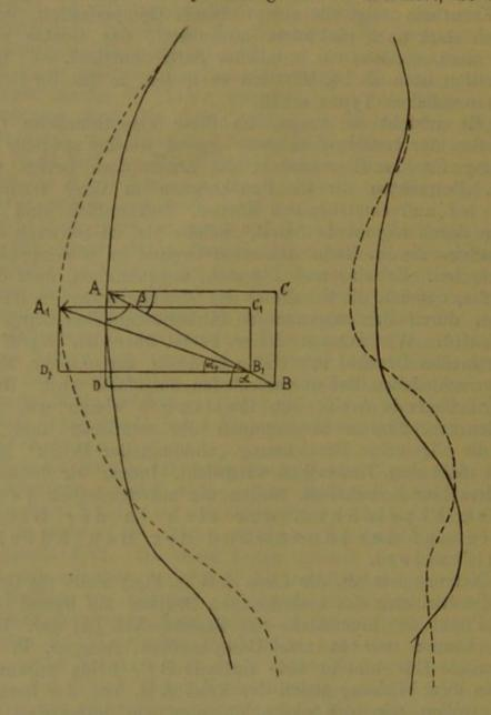
wir, dass unsere Kraft B C = A B.  $\sin \beta$ , oder nachdem  $\alpha$  und  $\beta$  sogenannte Wechselwinkel sind, daher gleich sind, können wir sagen, dass B C = A B.  $\sin \alpha$ , das heisst mit anderen Worten: die Grösse der verticalen Kraft B C wird immer von  $\sin \alpha$  abhängen. Warum? Da A B eine Constante ist, so kann sich das Product der Multiplication (A B.  $\sin \alpha$ ) nur ändern, wenn
