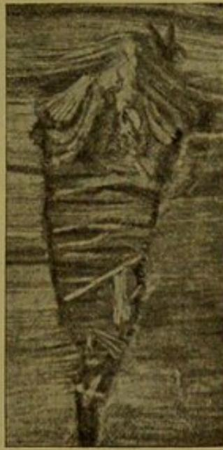
Schuss mit Bleispitzgeschoss in trockenes Buchenholz aus einer Entfernung von 25 Metern. Trichterförmiger Schusskanal von 12 Zentimetern Länge.
