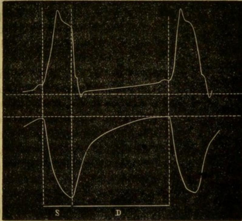
FIG. 6. — Schéma de l'opposition des courbes des pulsations du cœur (ligne supérieure) et des courbes des changements de volume (ligne inférieure). — *D*, période de réplétion diastolique (augmentation de volume). *S*, durcissement systolique (diminution de volume).
