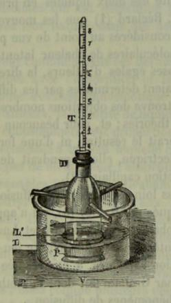
V, vase inférieur contenant de l'eau; P, membrane adaptée sur le tube intérieur; L, niveau de l'eau dans le vase inférieur; L', hauteur de la membrane ajustée sur le tube, dont le bord supérieur ne doit pas s'immerger; D, tubulure en caoutchouc; T, tube gradué.
