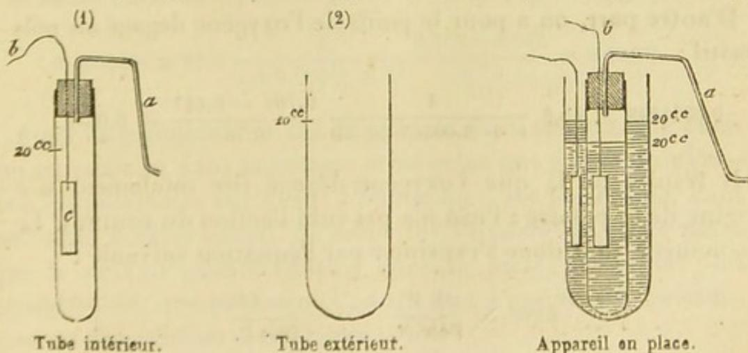
en communication avec le pôle positif d'une pile, le courant passera du tube intérieur au liquide extérieur par la petite ouverture de communication placée à la partie inférieure de l'appareil. Il est évident maintenant que si l'on fait dégager le gaz intérieur sous une pression de 15 millim., les liquides contenus dans chaque compartiment seront égaux.
