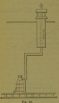
Luftschlot für das Ofenrohr; letzteres mit knieförmiger Biegung.
