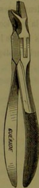
Fig. 13. Pincettes de M. GUÉRIDE pour tirer sur les cordes métalliques et les couper au besoin.
