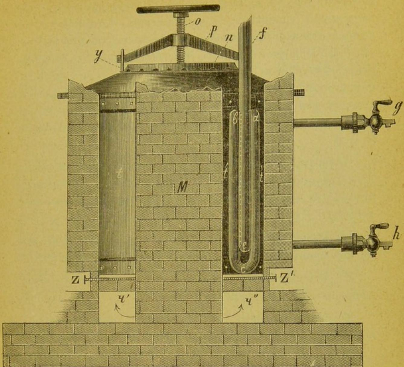
Въ дымоходѣ ( $r''$ .  $t'$ .  $t'$ .) помѣщаются паропроводная и пароотводная трубы. Дымоходъ ( $r'$ .  $t$ .) слѣва служить для выхода дыма до образованія паровъ въ котлѣ. Каждый дымоходъ имѣеть свою задвижку ( $Z-Z'$ ). Дымоходы раздѣлены каменною стѣнкою ( $M$ ) до дна очага. Выше котла оба дымохода соединяются въ одной трубѣ.
