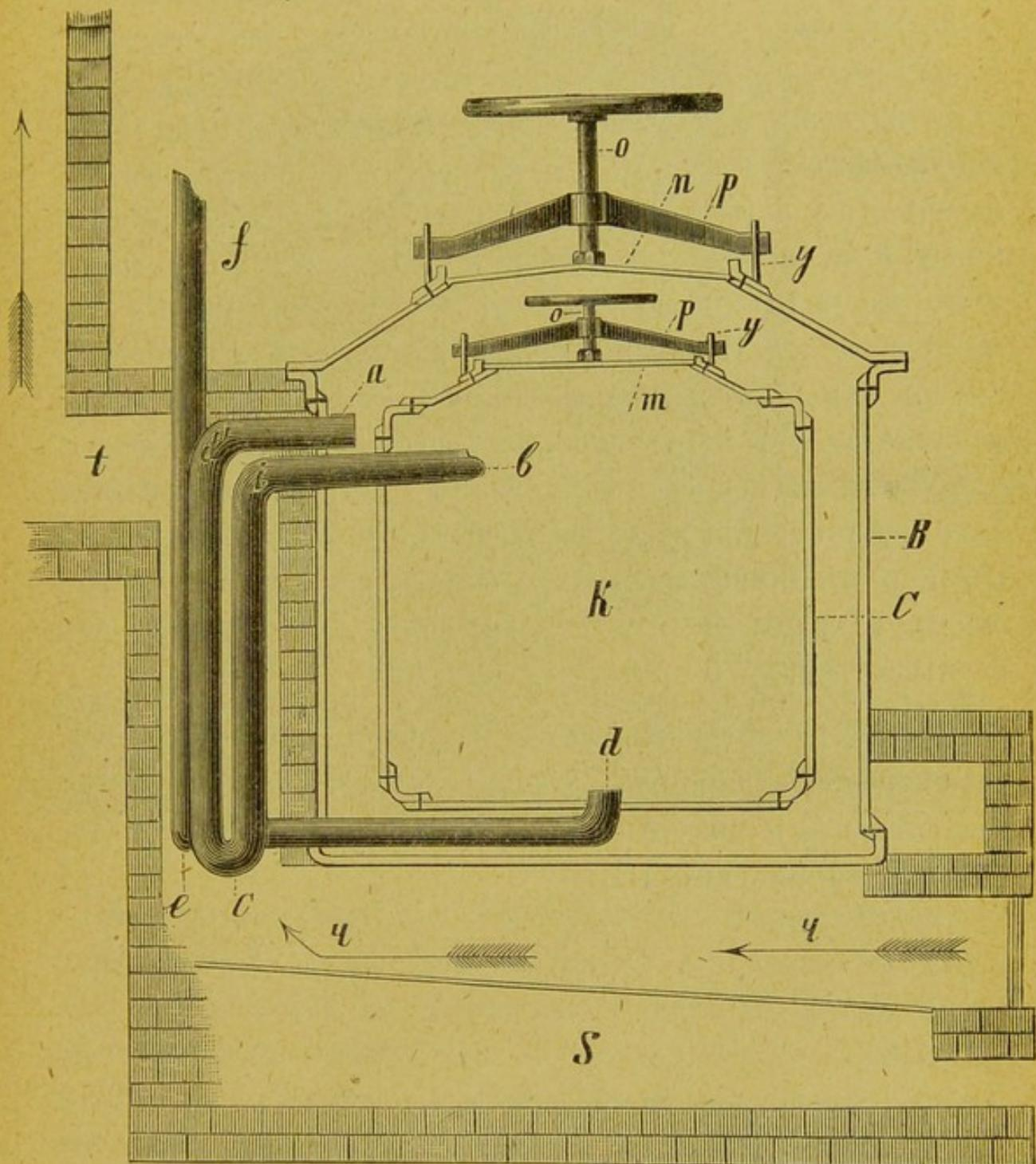
В — наружный котель; С — внутренний; К — камера, гдѣ помѣщаются вещи для дезинфекціи, ~~и~~ и ~~и~~ крышки обоихъ котловъ, которые плотно ~~и~~ привинчиваются ~~къ~~ краямъ цилиндровъ посредствомъ особо устроенныхъ ~~и~~ ры-
