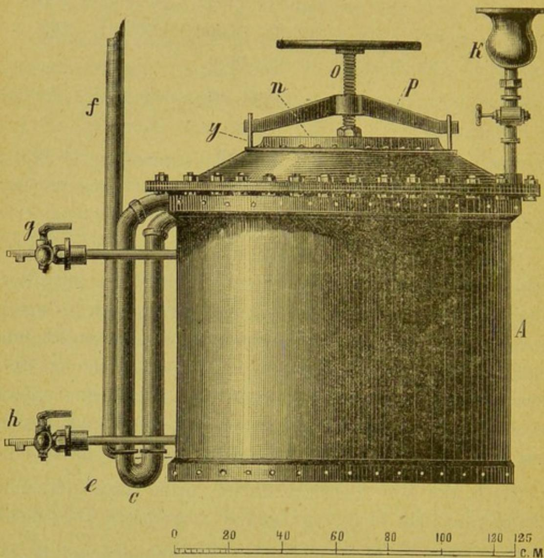
А.—общій видъ аппарата; к—воронка съ краномъ для вливанія воды въ пространство между цилиндрами; достаточность которой узнается тѣмъ, что вода наливаемая въ котелъ, должна вытекать изъ верхняго крана (g). Кранъ (h) служить для выливанія воды изъ аппарата.
